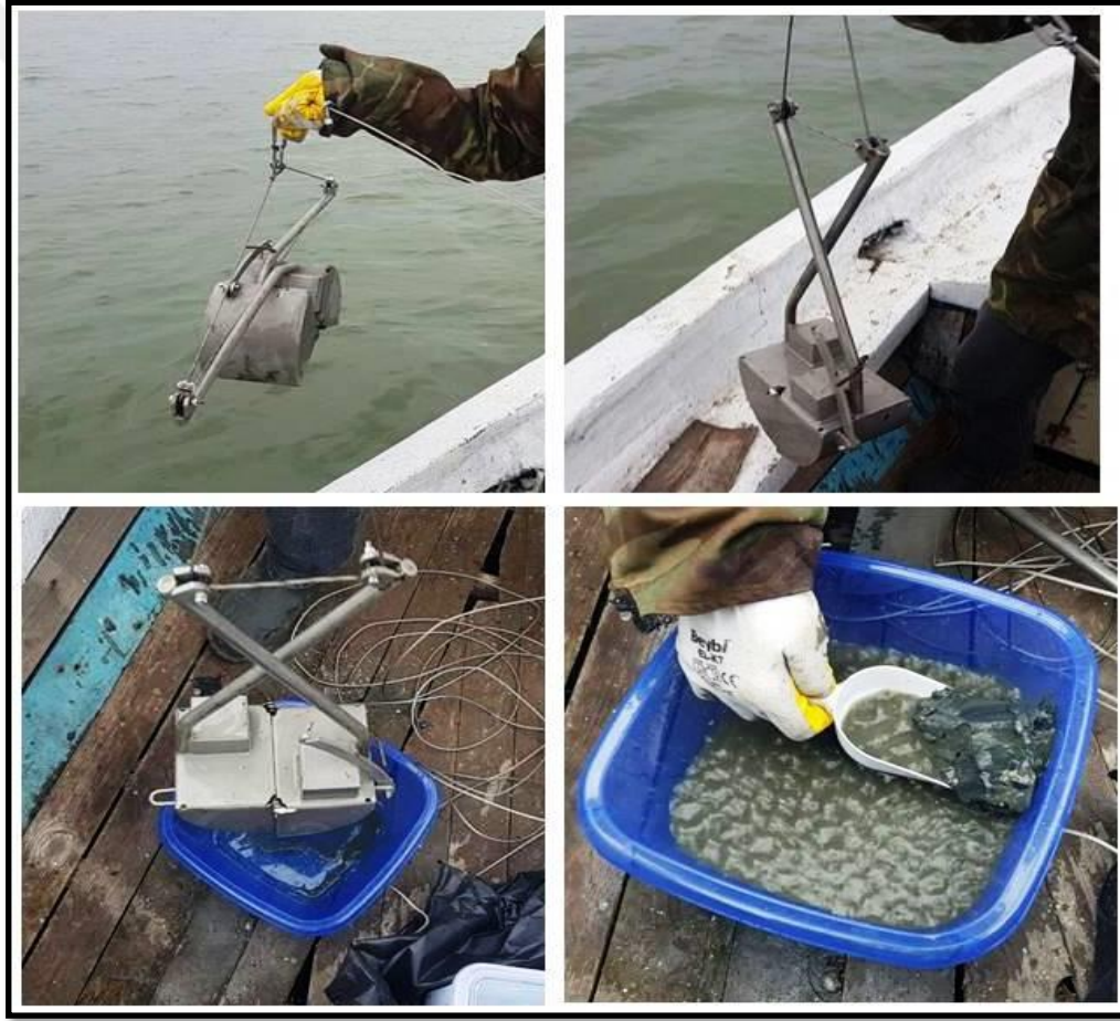
Şekil 3.1. Tez konusu kapsamında belirlenen 4 gölden Van Veen Grab yöntemi kullanılarak örneklerin toplanması
