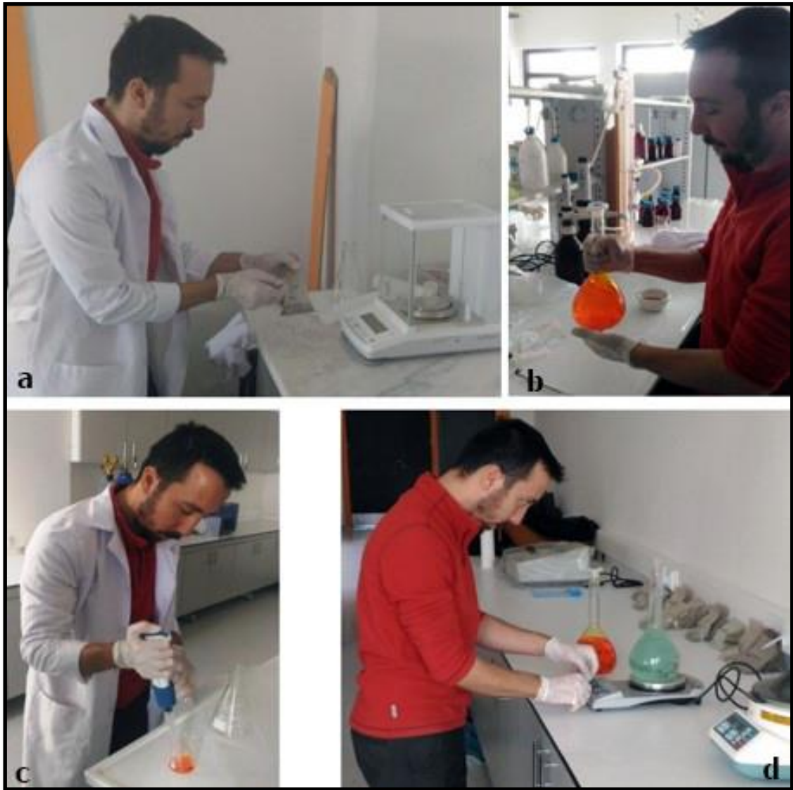
Şekil 3.8. Sediment örneklerin organik karbon tayini laboratuvar çalışmaları (a )elekten geçirilmiş kuru örneklerin hassas teraziile tartılması, b)tartılan örneklerin erlene yerleştirilmesi c)Sülfirik asit eklenmesi, d)çözeltinin saf su ile seyreltilmesi)
