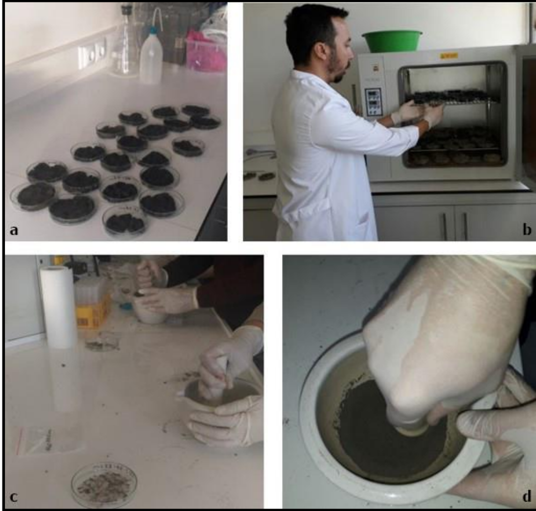
Şekil 3.7. Alınan örneklerin kurutulması ve sonrasında analizlere hazır hale getirilmesi: (a) Alınan örneklerin kurutma işlemi öncesinde petri kaplarına konması, b) Örneklerin etüvde kurutma işlemi, c-d) Porselen havanda kurutulmuş örneklerin dövülmesi.)
