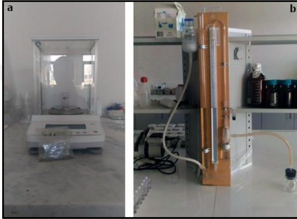
Şekil 3.10. Karbonat tayini sırasında kullanılan Hassas terazi, Scheibler kalsimetresi, Kalsimetre şişesi (tepkime şişesi).
