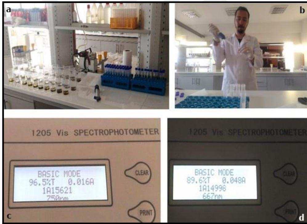
Şekil 3.11. Sedimentte klorofil tayini aşamaları ve spektrometre değerleri. (a)ıslak halde ayrılan örneklerin aseton ilekarıştırılması, b)sediment ile çözeltinin ayrılması, c-d) Çözeltinin spektrofotometrede 667 ve 750 nm’de okunması)
