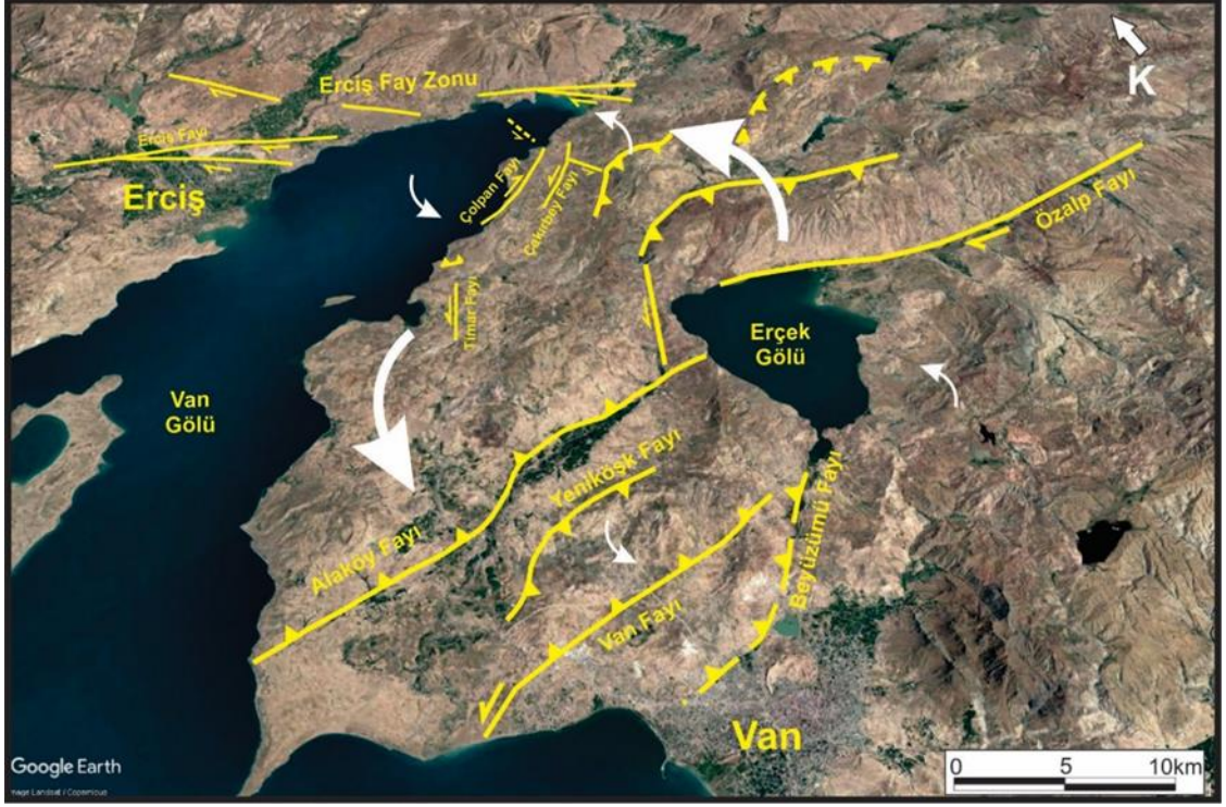
Şekil 5.3. Van Gölü doğu ve kuzeydoğusuna gözlenen ana faylar dönme hareketi yönleri (beyaz oklar).
