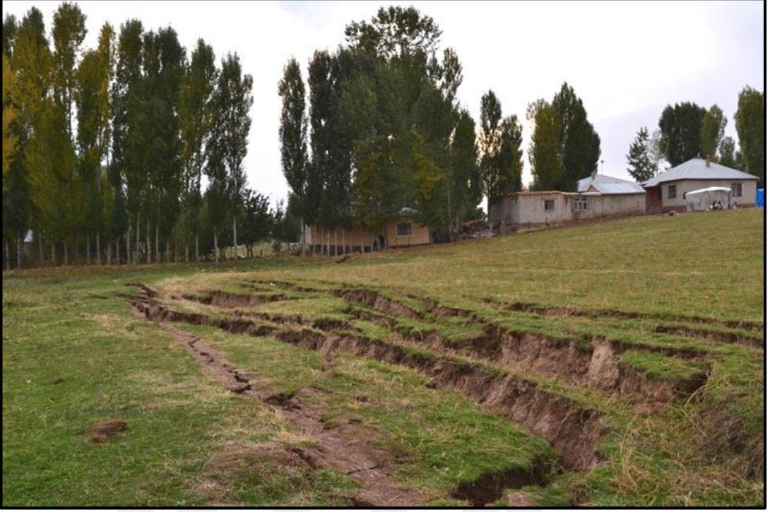
Şekil 4.170. Çelebibağı yerleşiminde gözlenen yanal yayılmalar, bakış yönü KB.
