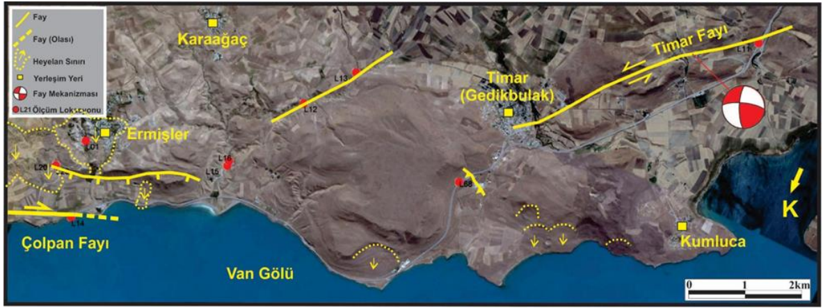
Şekil 4.140. Ermişler – Timar civarında gözlenen faylar, Timar Fayı mekanizma çözümü ve çevredeki heyelanlar (altlık GoogleEarth).
