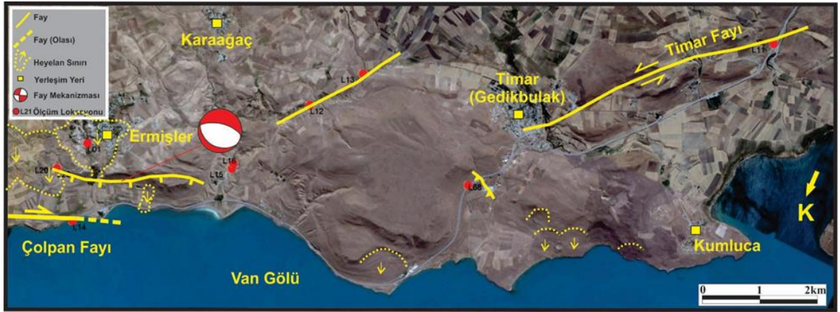
Şekil 4.134. Ermişler – Timar civarında gözlenen faylar, Ermişler Fayı mekanizma çözümü ve heyelanlar (altlık GoogleEarth).
