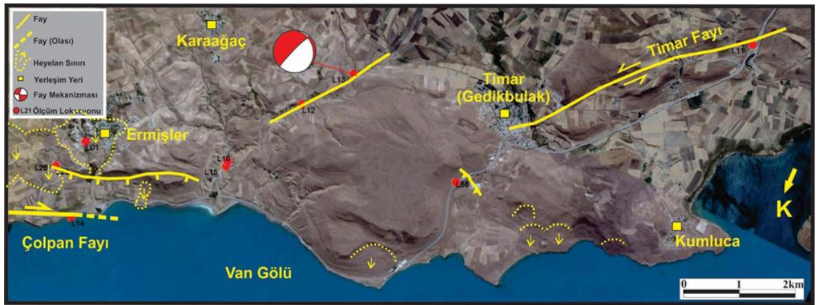
Şekil 4.144. Ermişler – Timar civarında gözlenen faylar, L13 Fayı mekanizma çözümü ve heyelanlar (altlık GoogleEarth).
