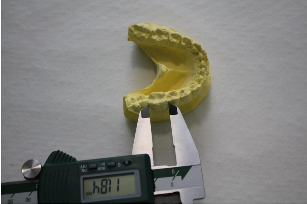
Resim 6: Alçı modelde sağ mandibular birinci molar dişin mesiodistal genişliğinin dijital kumpas ile ölçülmesi
