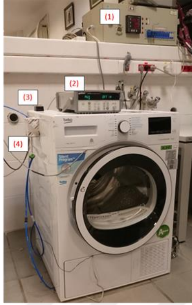
Şekil 4.5 : Veri toplama sistemi(1), data logger(2), nem ölçme cihazı(3), debi ölçme cihazı(4)
