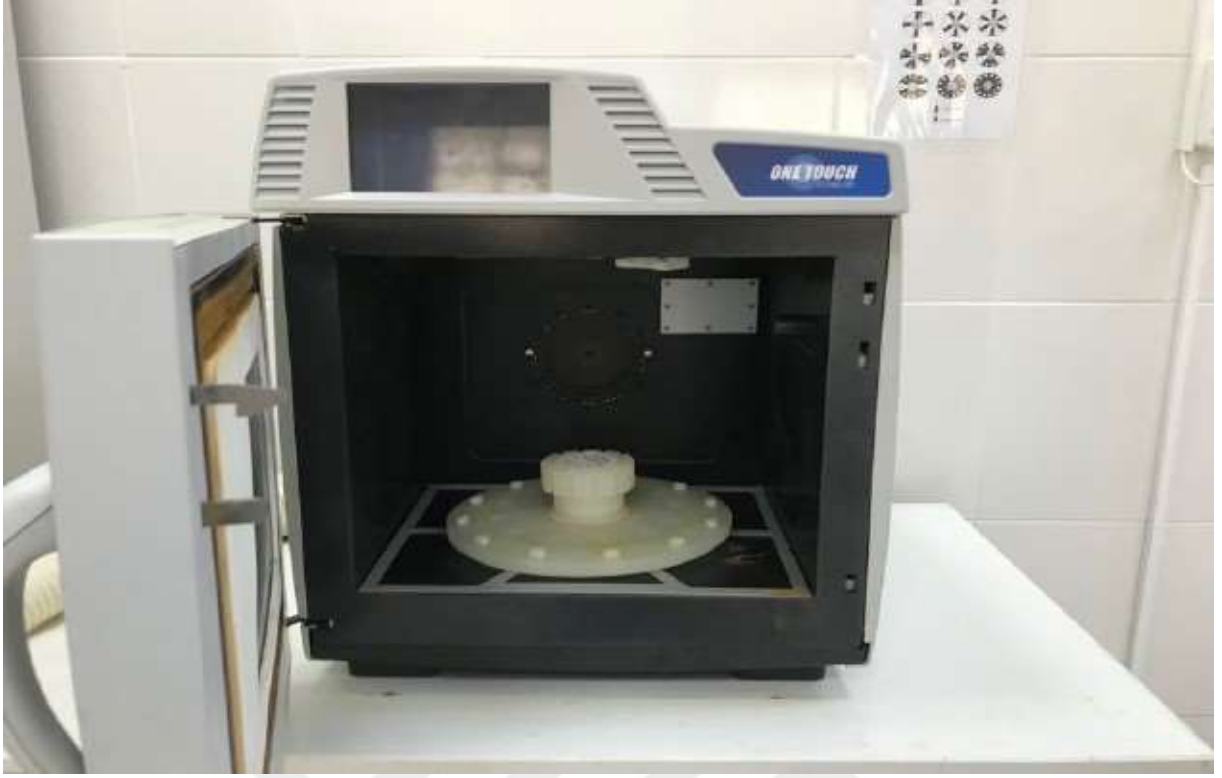
Şekil 37. PM10 ve PM2.5 filtrelerinin mikrodalgada yakılması
