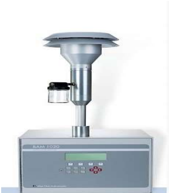
Şekil 33. BAM 1020 cihazı dıştan görünüm
