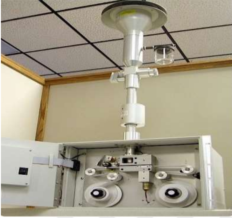
Şekil 34. BAM 1020 cihazı içten görünüm
