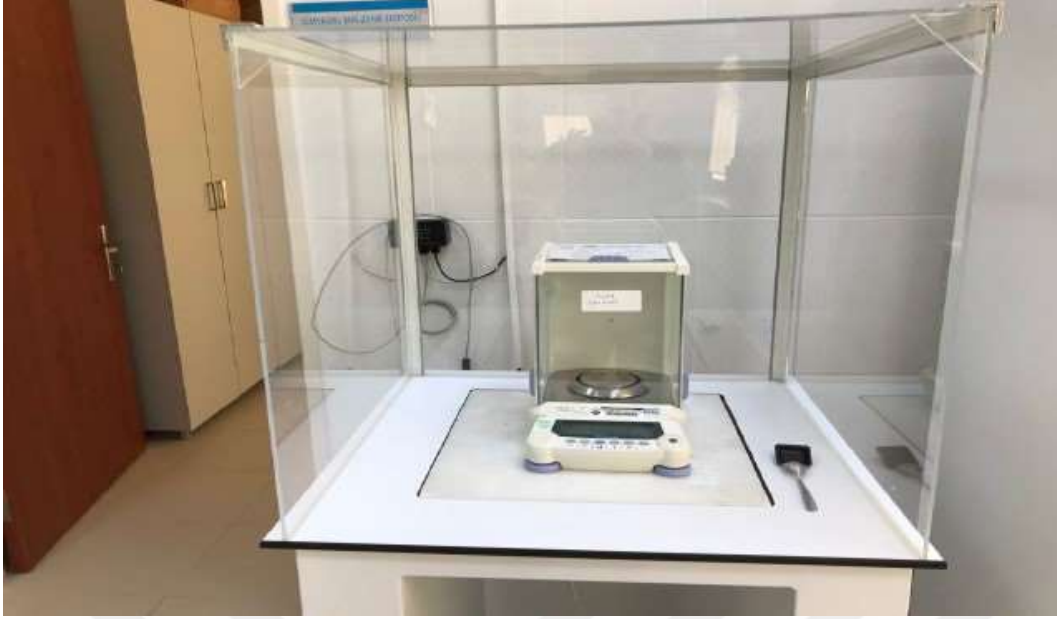
Şekil 35. PM10 ve PM2.5 disklerinin tartılması
