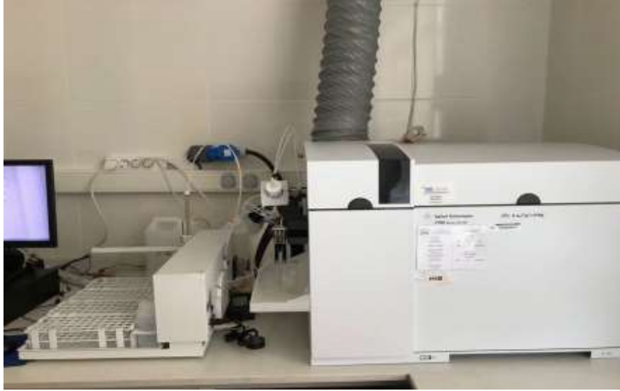
Şekil 38. PM10 ve PM2.5 filtrelerinin ICP-MS cihazında element analizi
