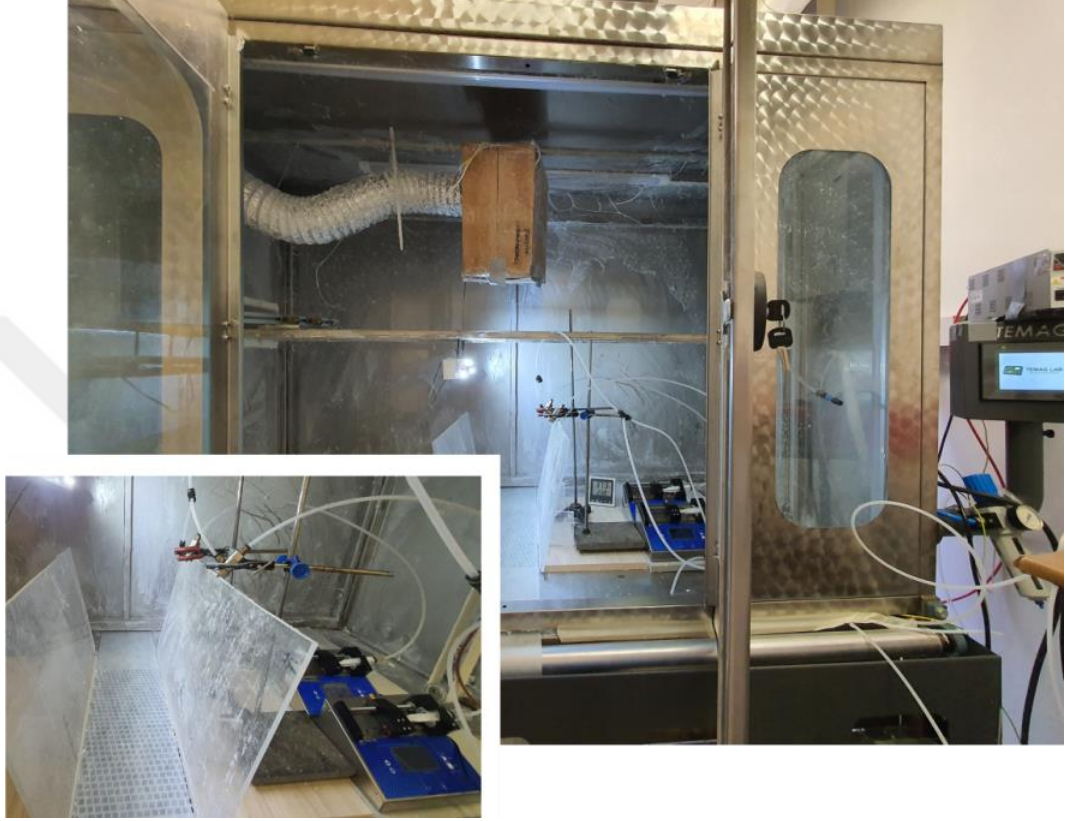
Şekil 3.1: SB yöntemi ile bimodal kumaş üretimi için deney düzeneği.
