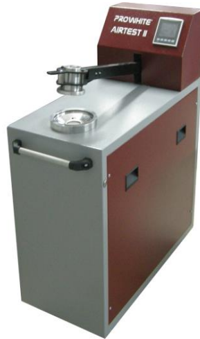
Şekil 3.6: Hava geçirgenlik cihazı.
