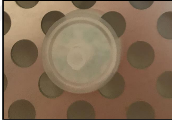
Şekil 4.15: 10^3 Cfu bakteri içeren standart – 2 saat bekledikten sonra.
