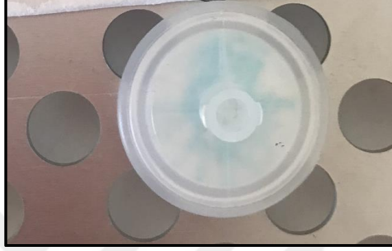
Şekil 4.14: 10^4 Cfu bakteri içeren standart – 1 saat bekledikten sonra.
