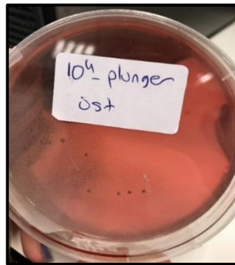
Şekil 4.4: 10^4 Cfu bakteri çözeltisi plunger tüpten tüpten geçirildikten sonra üstte kalan kısmın EMB agarda kontrolü.
