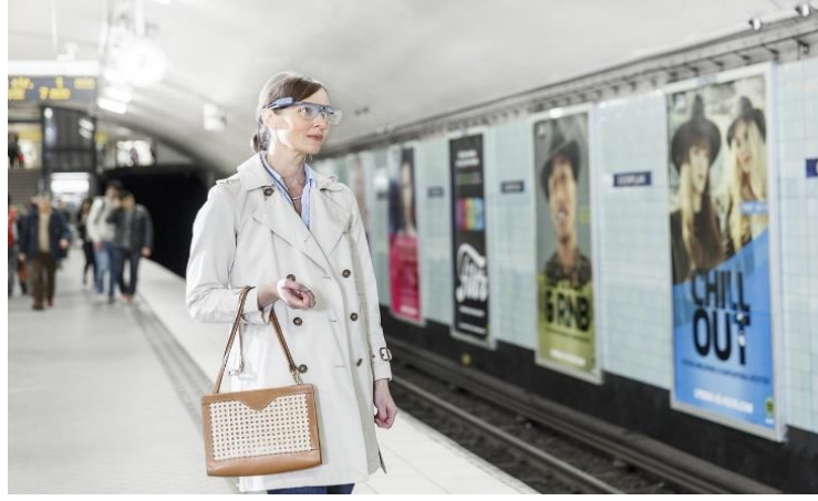
Şekil 2.10: Başa takılan (gözlük tarzı) göz izleme sistemi (Bilten, 2021).
