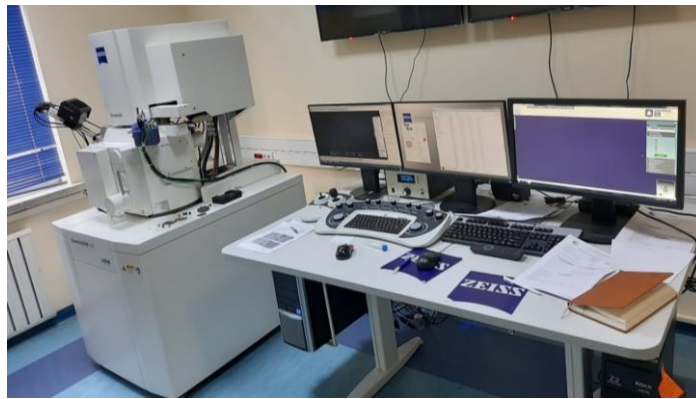
Şekil 20. Nano Ölçekli Görüntülerin Elde Edilmesinde Kullanılan SEM Cihazı.
