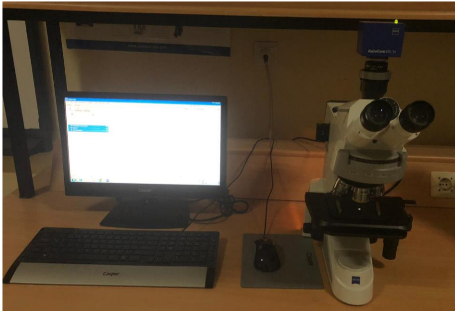
Şekil 18. Mikro Ölçekli Görüntülerin Alınmasında Kullanılan Bölüm Laboratuvarında Mevcut Zeiss Axio Lab A1 Optik Mikroskop Cihazı.
