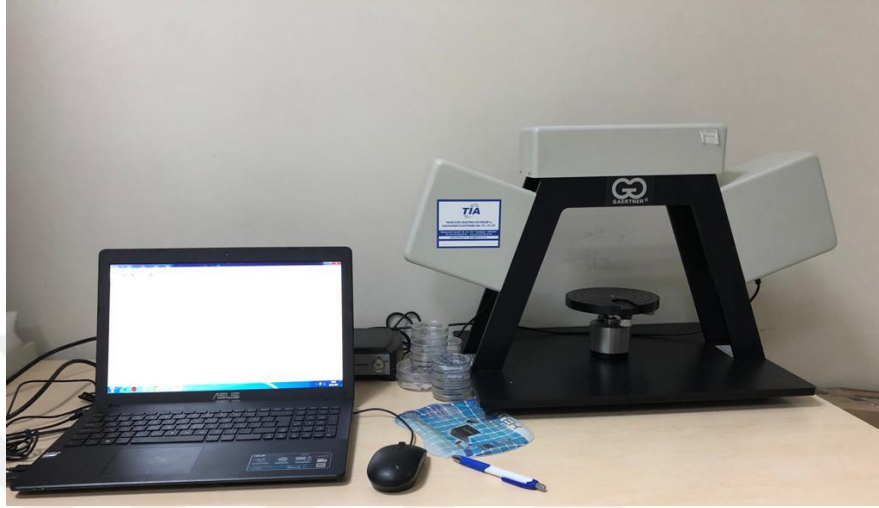
Şekil 16. Üniversite Araştırma Merkezinde Mevcut Elipsometre Cihazı.
