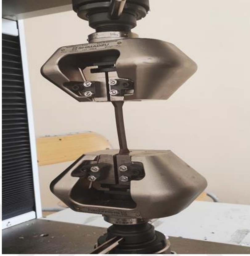
Resim 5.6. Çekme testine tabi tutulan polietilen ve muz lifi takviyeli standart çekme numunesi.
