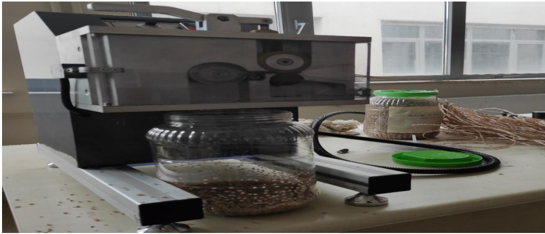
Resim 5.3. Ekstrüzyon makinasından çıkan polietilen muz lifi karışımının kırıcıdan geçirilerek granül haline gelmesi
