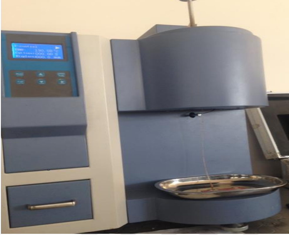
Resim 5.5. JPT EQUIPMANT marka XLR-400 model melt flow indexer cihazı
