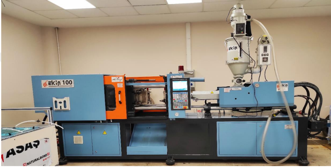
Resim 5.4. Munzur Üniversitesi Makine Mühendisliği laboratuvarı Ekin 100 Orion plastik enjeksiyon makinesi
