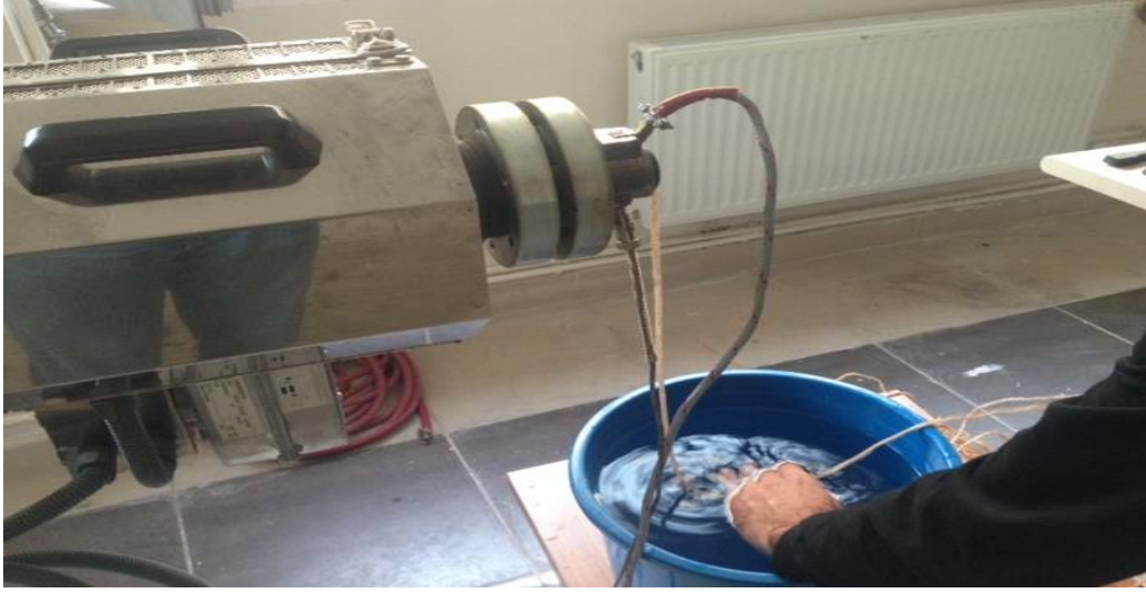
Resim 5.2. Polietilen muz lifi karışımının ekstrüzyon makinasından geçirilmesi
