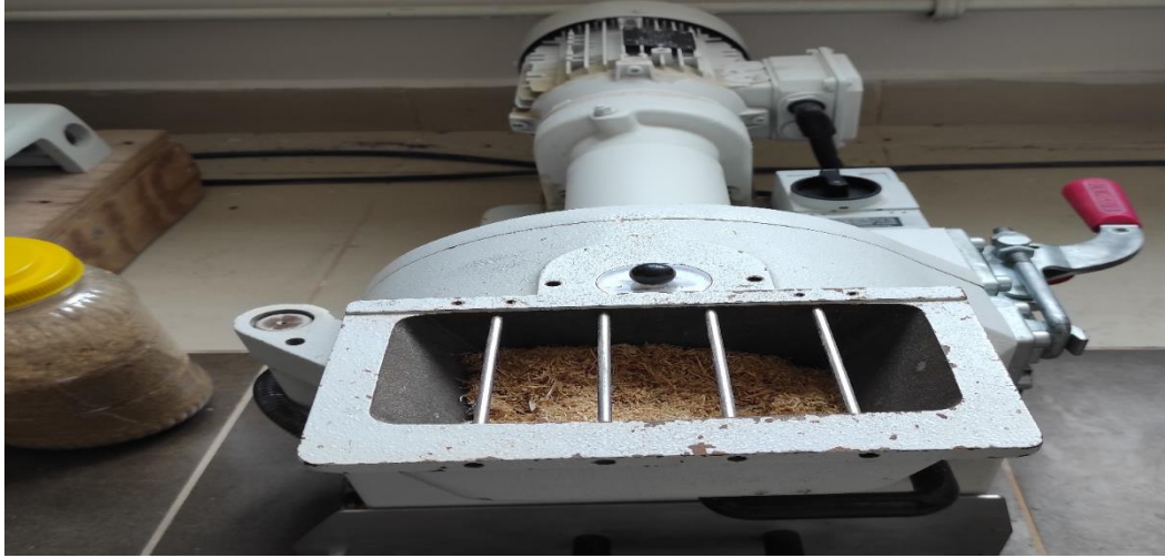
Resim 5.1. Doğal muz lifi dolgu maddesinin öğütülme işlemi
