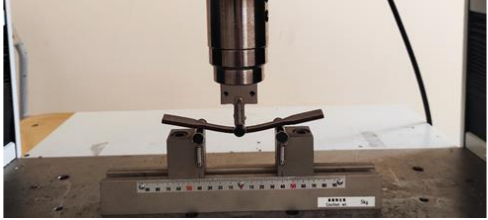
Resim 5.7. Üç nokta eğilmeye maruz polietilen ve muz lifi takviyeli standart çekme numunesi.
