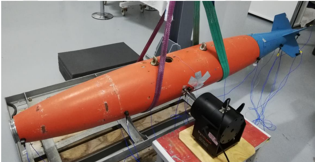
Resim 4.7. Tekli girdi çoklu çıktı sarsıcı testi
