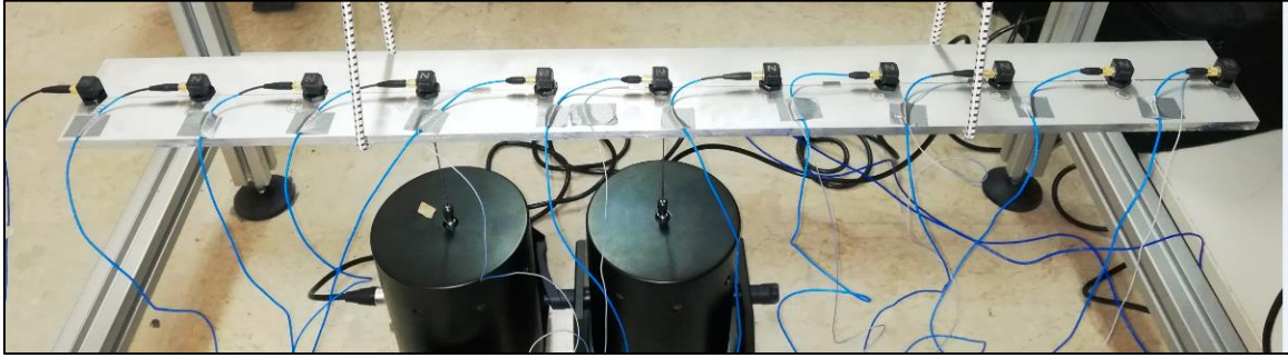
Resim 4.4. Tek eksenli iki noktadan modal sarsıcı ile tahrik durumu
