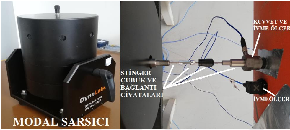
Resim 3.2. Modal sarsıcı ve bağlantı aparatlarının gösterimi
