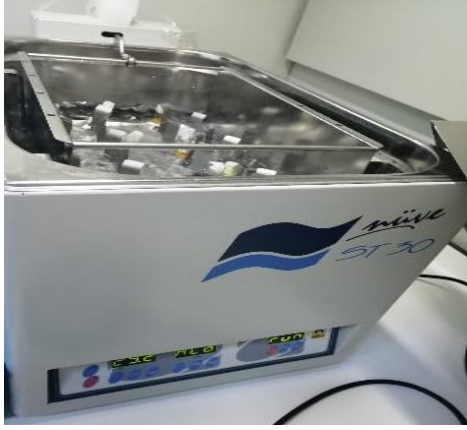
Şekil 3.2. Manyetit çapraz bağlı invertaz agregatlarının (MCLIA) çalkalamalı su banyosundaki hazırlanışı
