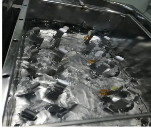
Şekil 3.2. Manyetit çapraz bağlı invertaz agregatlarının (MCLIA) çalkalamalı su banyosundaki hazırlanışı
