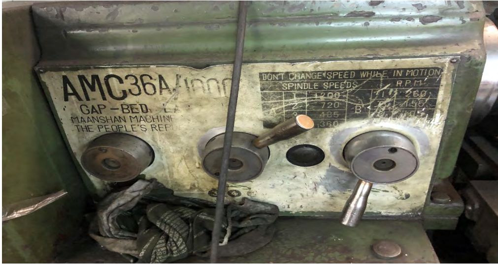
Resim 35: Kesme hızı ve devir kontrolü belli olmayan torna tezgahı
