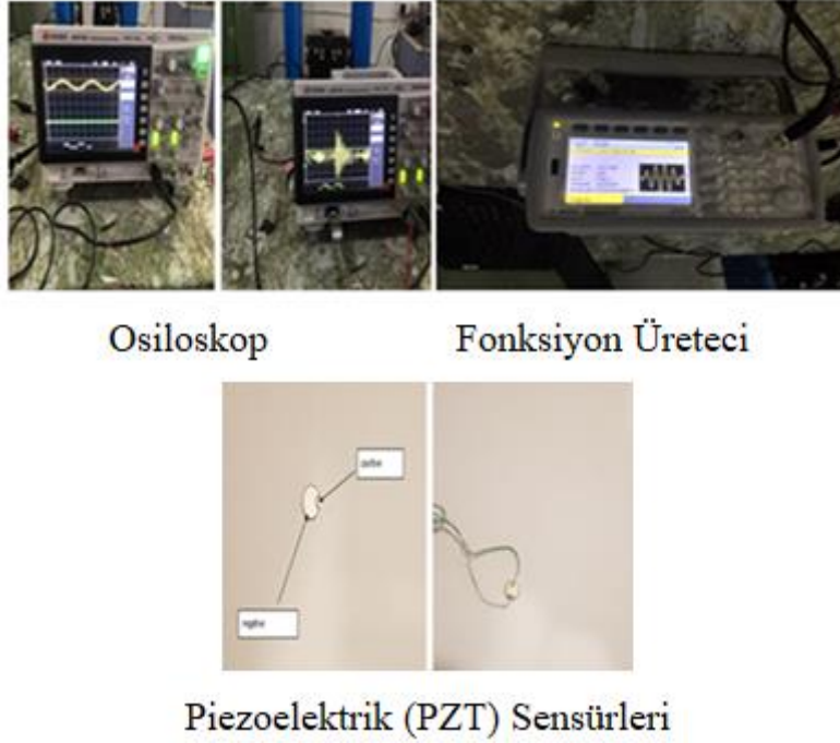
Şekil 1. Osiloskop, fonksiyon üretici cihazları ve piezoelektrik verici sensörü
