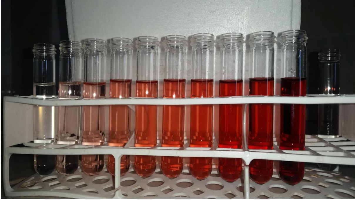
Şekil 4.2. Katesin kalibrasyon eğrisi hazırlama aşaması
