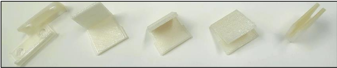
Resim 5.5. SMP model örneğinde eğilme hareketi ile menteşe olarak çalışma (Yoon, 2019)
