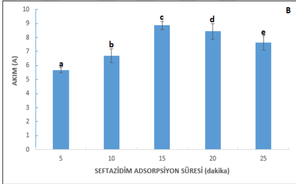
Şekil 4.6. SEF immobilizasyon çalışmasının sinyale olan yanıtı: ct dsDNA ile immobilize edilen PGE'ler SEF içerisinde (a) 5 (b) 10 (c) 15 (d) 20 (e) 25 dakikalarda bekletilerek SWV yöntemiyle SEF sinyallerini gösteren voltamogram (A) ve histogram (B)
