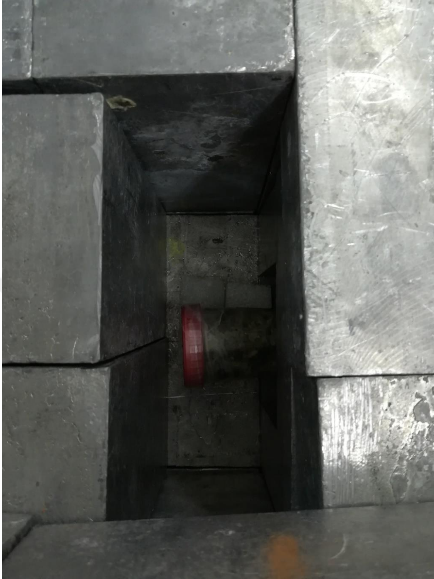
Şekil 3.26. HPGe dedektörde doğal radyoaktivite ölçümlerinin alınması
