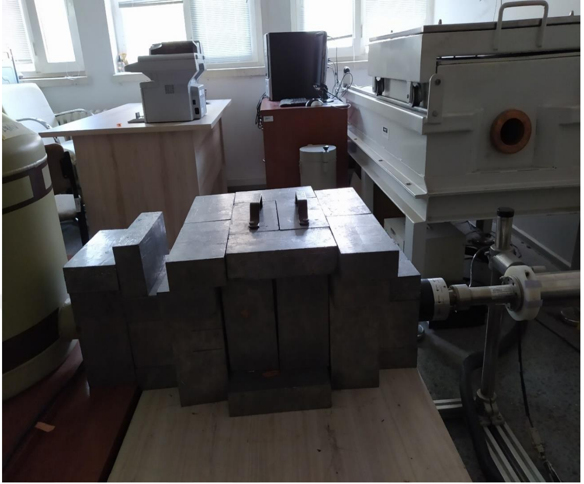
Şekil 3.25. Akdeniz Üniversitesi Fizik Bölümü Nükleer Fizik laboratuvarında bulunan yüksek saflıkta germanyum (HPGe) dedektörü
