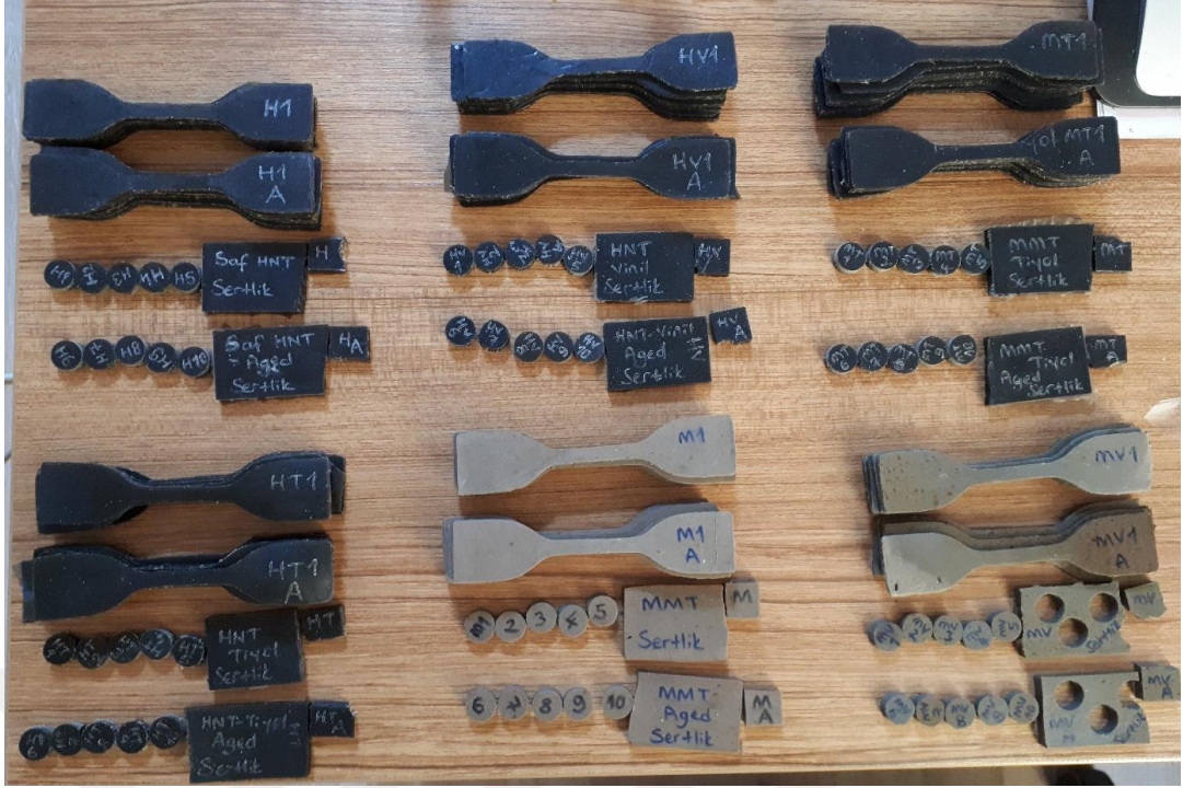
Şekil 4.34 Mekanik testler için hazırlanmış, saf ve fonksiyonlanmış HNT ve MMT nanodolguları içeren yaşlandırılmamış ve yaşlandırılmış SBR nanokompozitleri.
