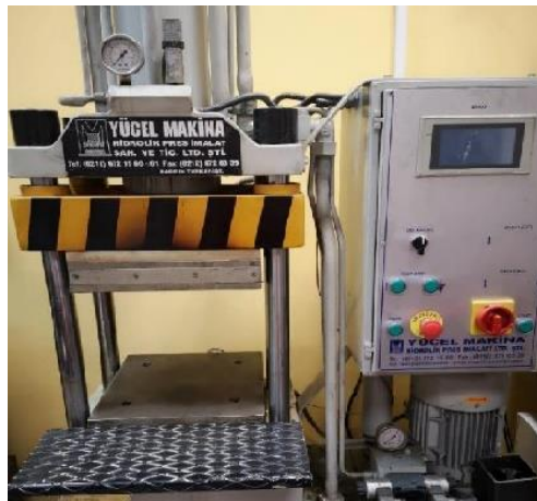
Şekil 3.6 Laboratuvar tipi hidrolik pres.
