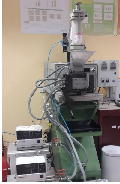
Şekil 3.3 Kauçuk hamurlarının hazırlanmasında kullanılan laboratuvar tipi banbury.
