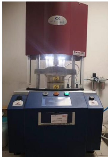
Şekil 3.4 Alpha pioneer 2000 döner kalıp reometresi.
