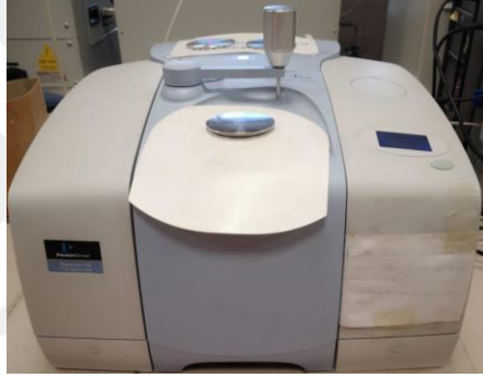
Şekil 3.7 Fourier dönüşümlü kızılötesi spektrometresi (FT-IR).
