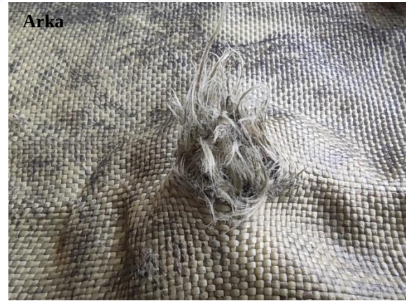
Şekil 4.33. Twaron 200 kumaşları ile üretilen a-b) KAKS c-d) KAKS/SiC-B e-f) KAKS/SiC-B+GNP-A kodlu numunelerin balistik test sonrası resimleri
