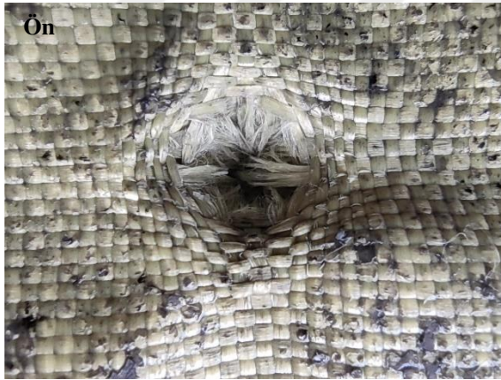
Şekil 4.33. Twaron 200 kumaşları ile üretilen a-b) KAKS c-d) KAKS/SiC-B e-f) KAKS/SiC-B+GNP-A kodlu numunelerin balistik test sonrası resimleri
