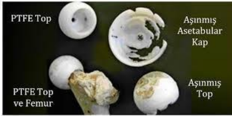
Şekil 15. Kalça protezinde meydana gelen aşınma (Q. Chen & Thouas, 2015).
