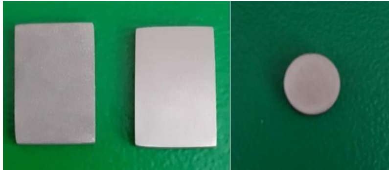
Şekil 23. Tel erozyon ile istenilen boyutlarda çıkarılan TNTZ numuneler
