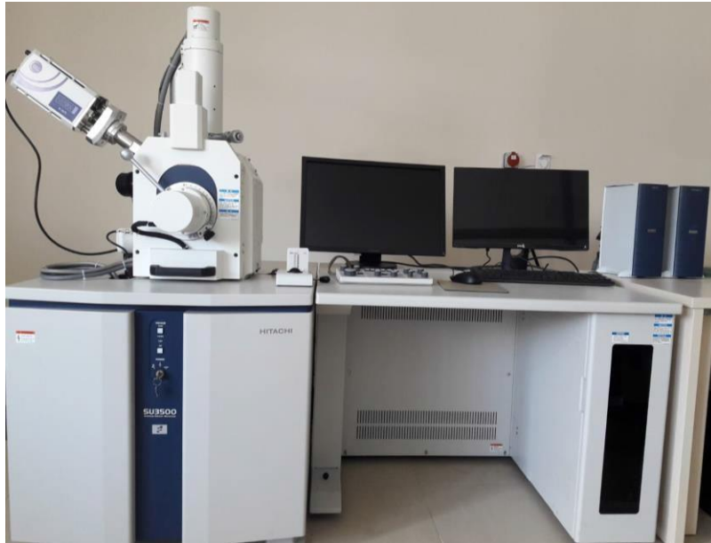
Şekil 28. SEM cihazı (HITACHI SU3500)
