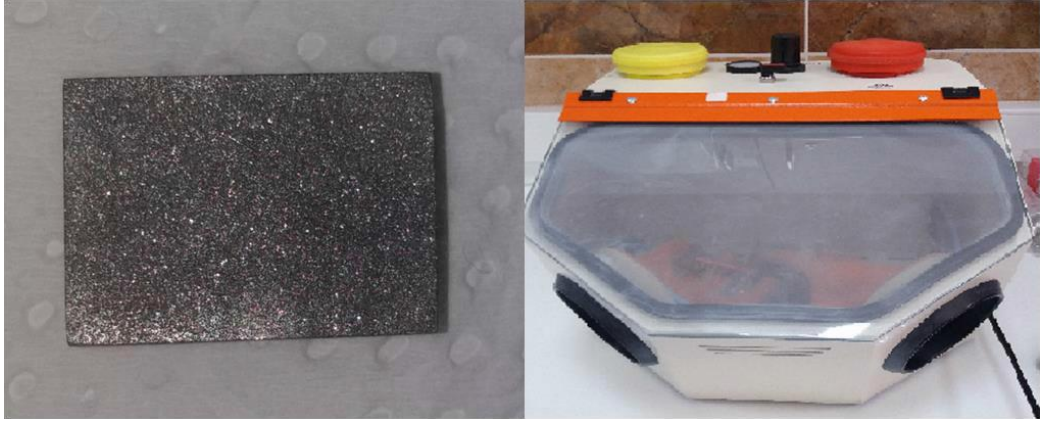
Şekil 25. Kumlanmış numune yüzeyi ve kumlama cihazı
