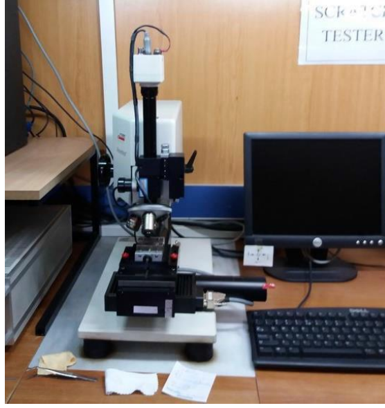
Şekil 32. Çizme (Scratch) test ünitesi (RST S/N:11-0175)
