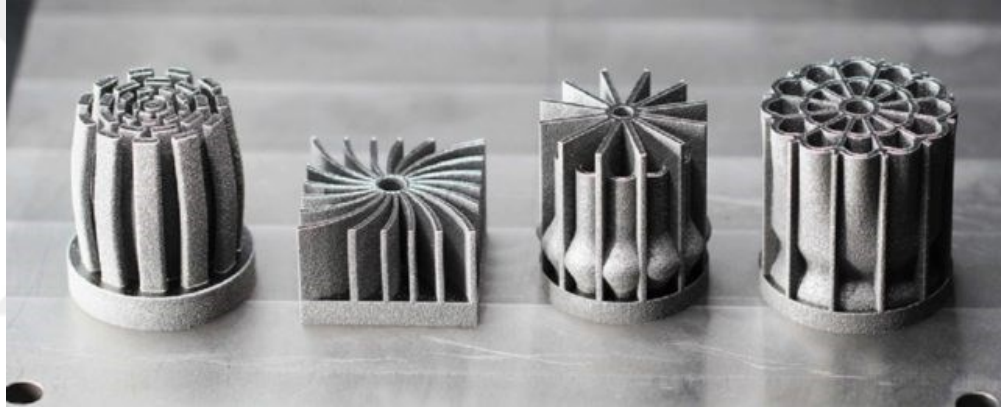
Şekil 1.8 Katmanlı imalat ile üretilmiş ısı kuyuları (Illumarco, 2019)
