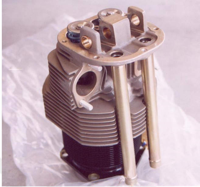
Şekil 1.4 Cessna 140 uçaklarında kullanılan Continental C-85 havacılık motor silindiri üzerindeki ısı kuyusu görevi gören bütünleşik kanatçıklar (Air-Cooled Engine - Wikipedia, n.d.)
