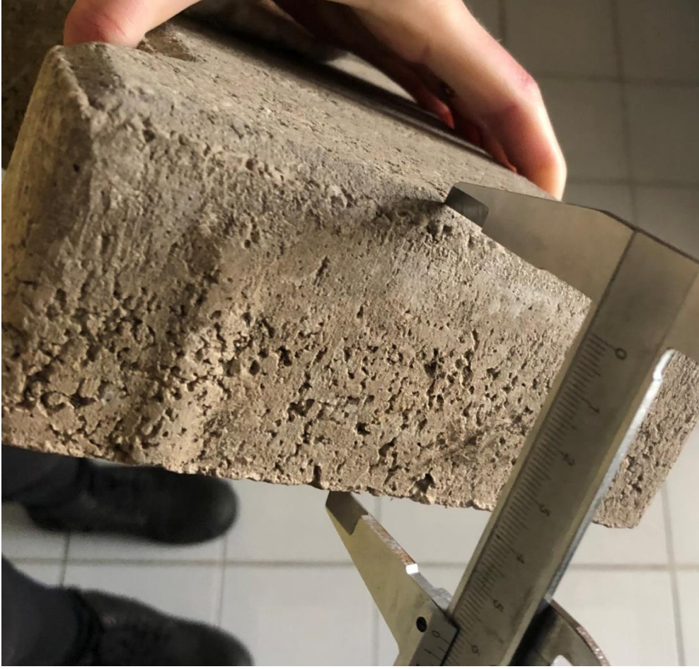
Şekil 3.11. Kilitli beton parke taşı numunesinin kalınlık ölçümü
