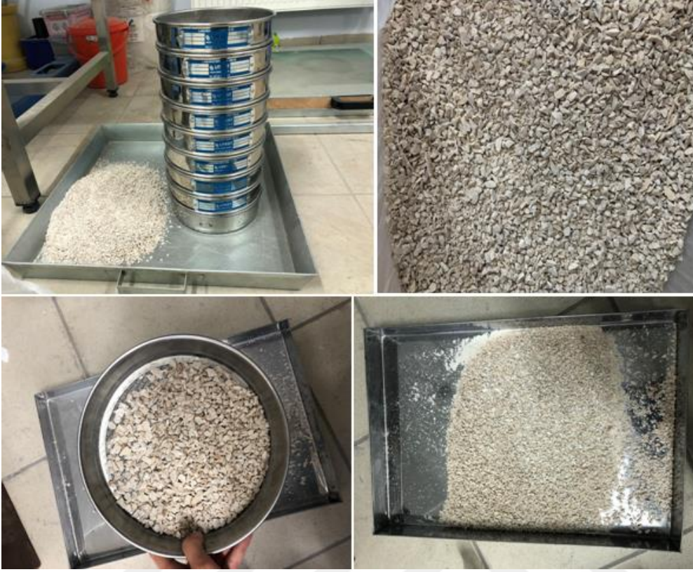
Şekil 3.5. Elek analizi deney düzeneği ve deneyin yapılışı
