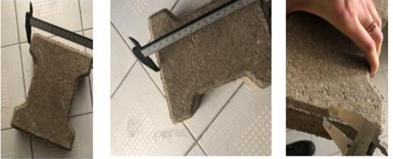
Şekil 3.10. Kilitli beton parke taşı numunesinin en, boy ve pah ölçümü
