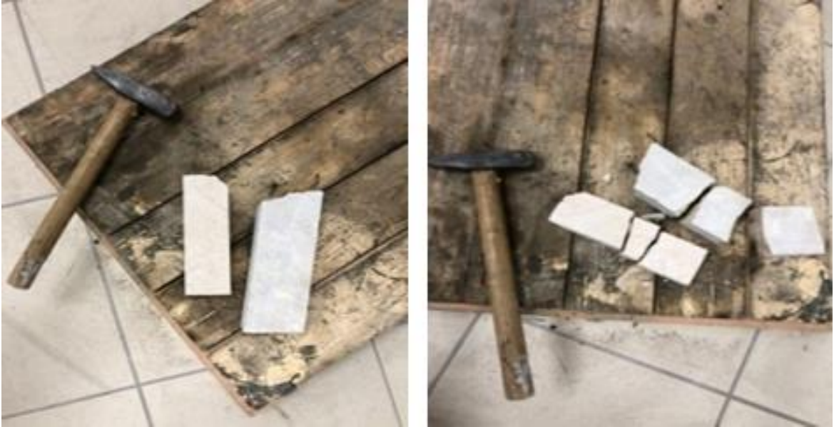
Şekil 3.2. Laboratuvar tipi küçük konkasör için parçalanmış mermer parçaları
