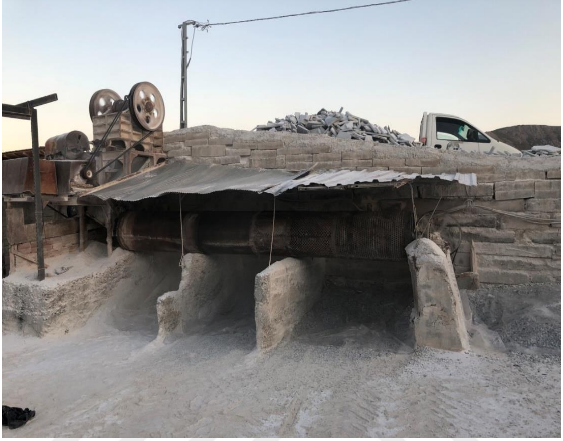
Şekil 3.4. Atık mermer ince agregasının elde edilişi
