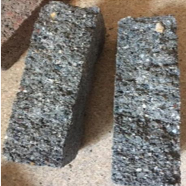
Şekil 3.15. Yarmada çekme deneyi sonucu kırılmış numune
