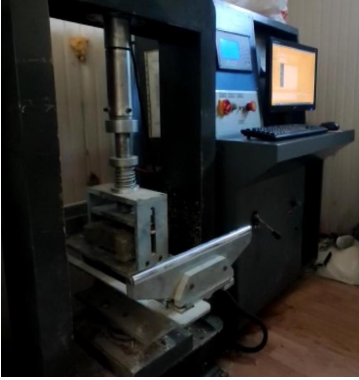
Şekil 3.14. Yarmada çekme deneyi yapılışı
