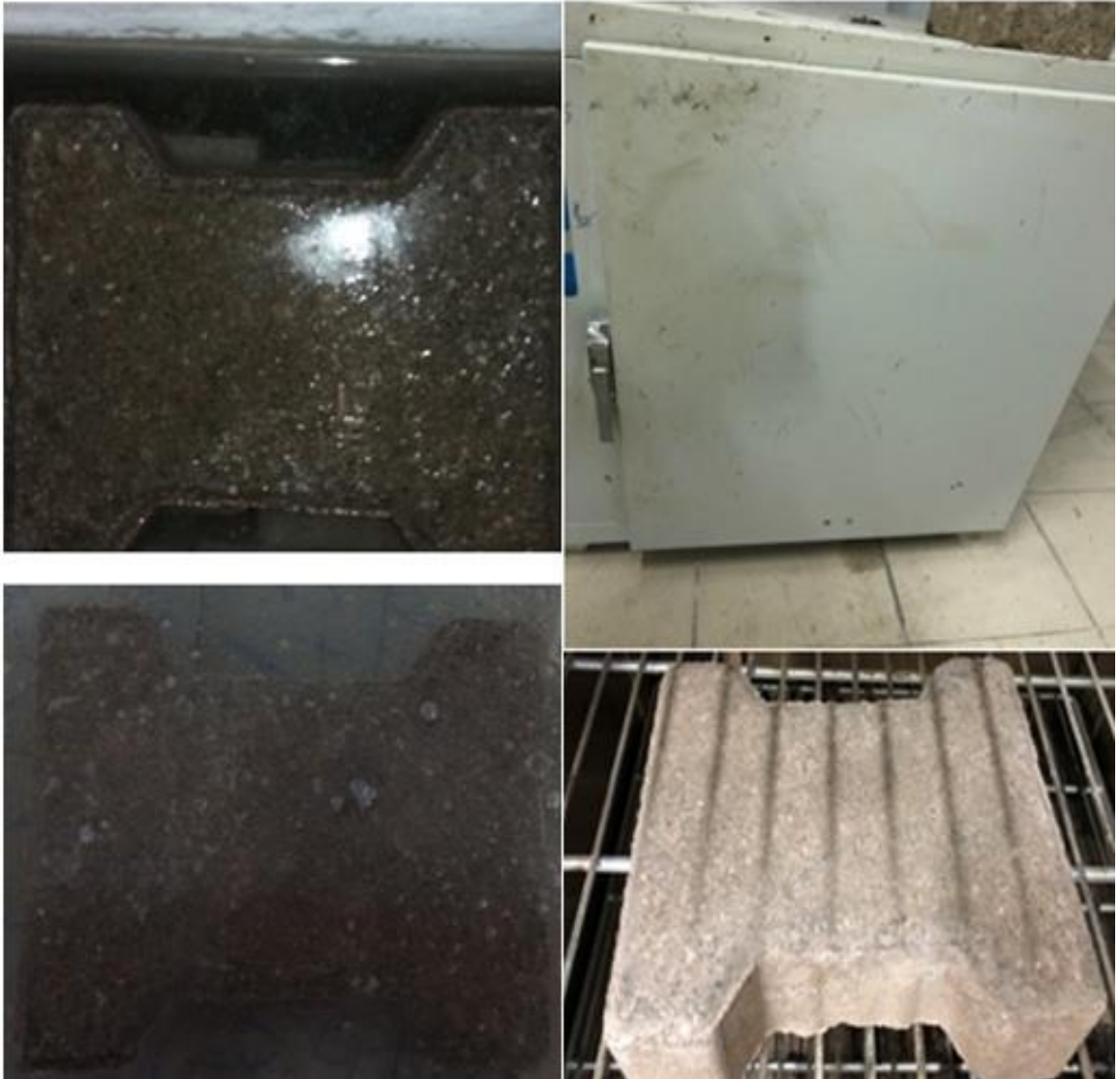
Şekil 3.16. Su emme oranı tayini deneyine tabi beton parke numunesi
