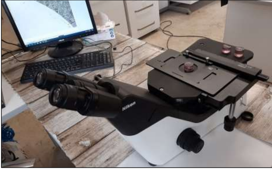
Şekil 6.17. NİKON- MA100N optik metal mikroskobu ve bilgisayar düzeneği
