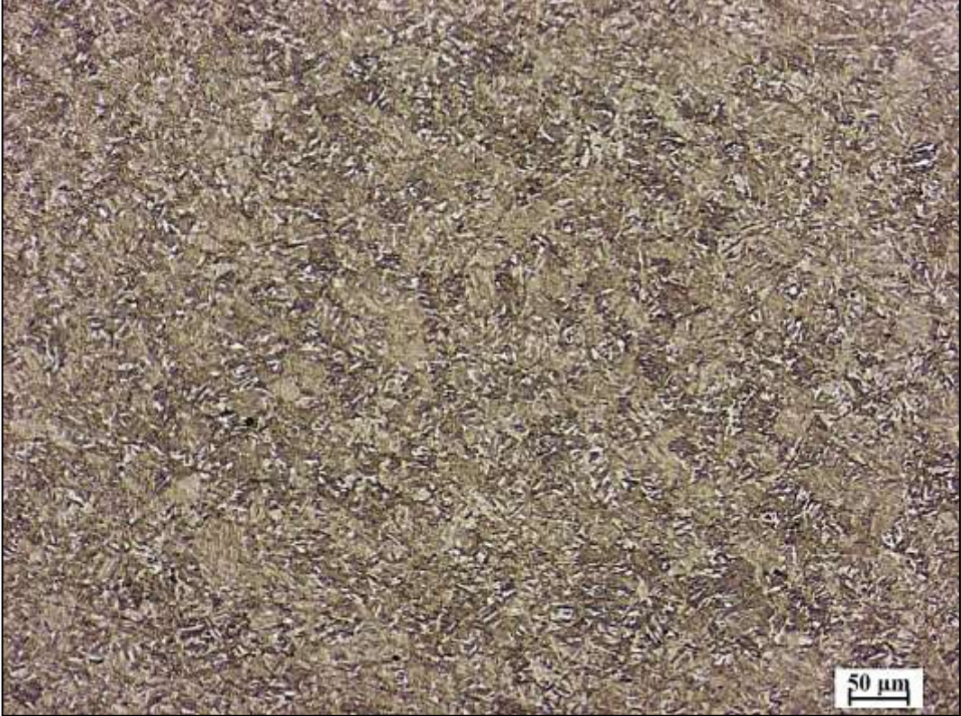
Şekil 7.8. 100X büyütmede Armox500T zırh çeliğine ait mikroyapı görüntüsü
