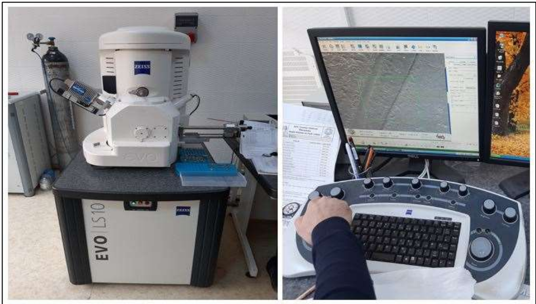
Şekil 6.18. Taramalı elektron mikroskobu (SEM) ve bilgisayar destekli kontrol ünitesi
