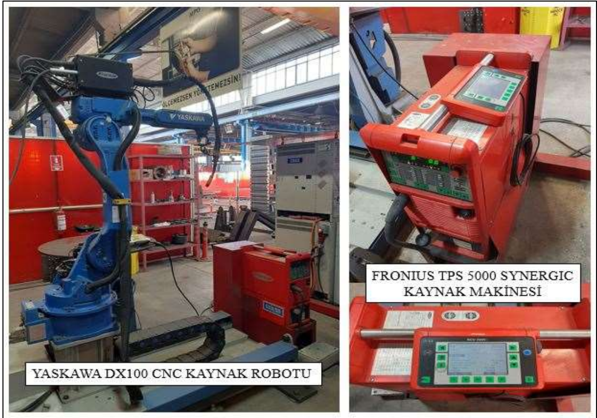
Şekil 6.2. Kaynak işlemi için kullanılan mekanize gazaltı kaynak ekipmanları
