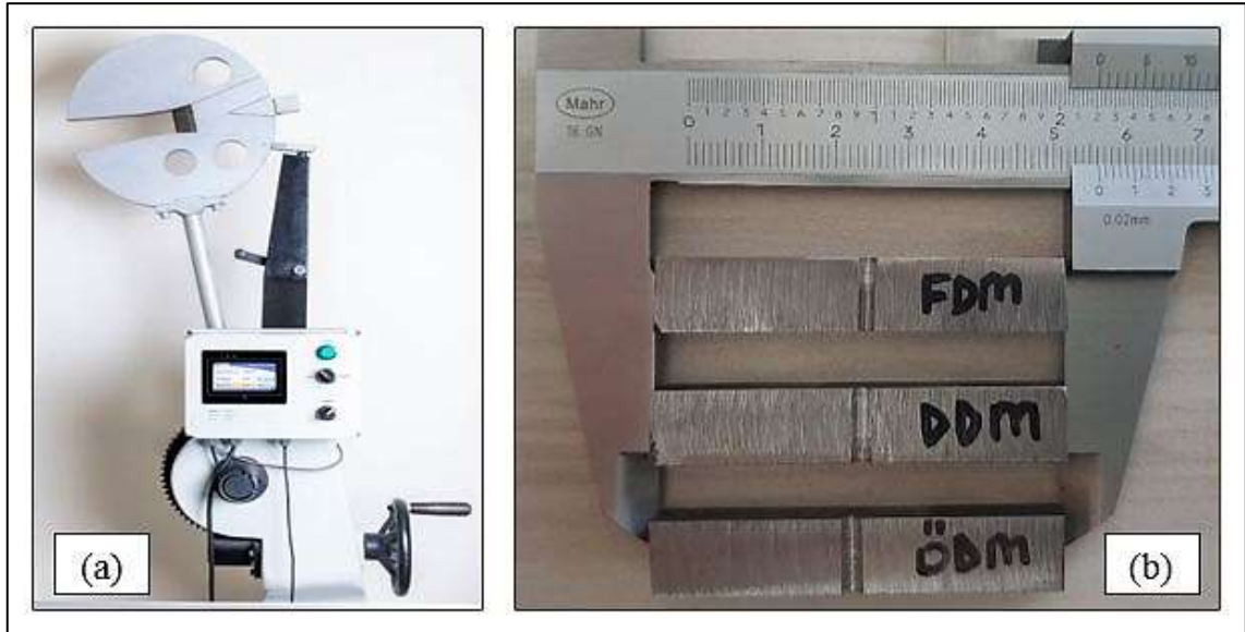
Şekil 6.13. (a) ALŞA marka 300 J kapasiteli çentik darbe test cihazı, (b) kullanılacak çentik testi numuneleri
