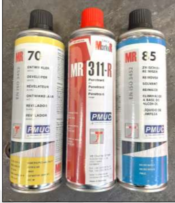
Şekil 6.6. Sıvı penetrant muayenesinde kullanılan sıvı ekipmanlar (soldan sağa; MR70-geliştirici, MR311R-kırmızı penetrant ve MR85-temizleyici solvent)
