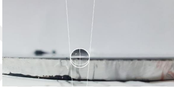
Şekil 3.38. Su damlasının DTY5 numunesi üzerindeki duruşunun temas açısı tayini.
