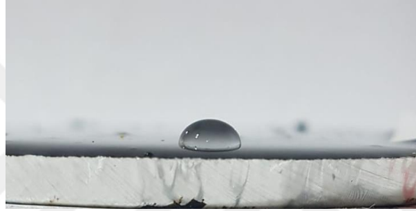
Şekil 3.41. Su damlasının HY5 numunesi üzerindeki duruşu.
