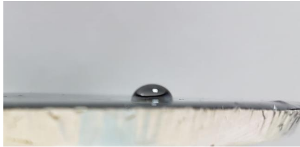
Şekil 3.39. Su damlasının KY7 numunesi üzerindeki duruşu.
