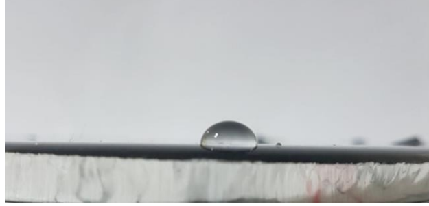
Şekil 3.37. Su damlasının DTY5 numunesi üzerindeki duruşu.
