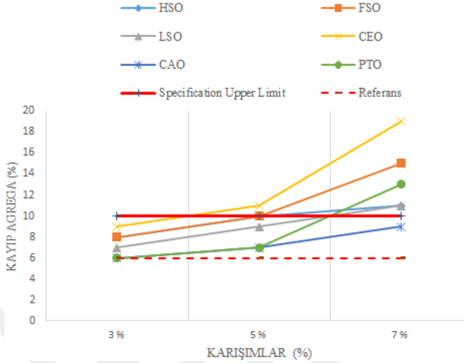
Şekil 3.29. Vialit deneyinin sonuçları.
