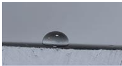
Şekil 3.30. Su damlasının bitümlü karışım üzerindeki duruşu.
