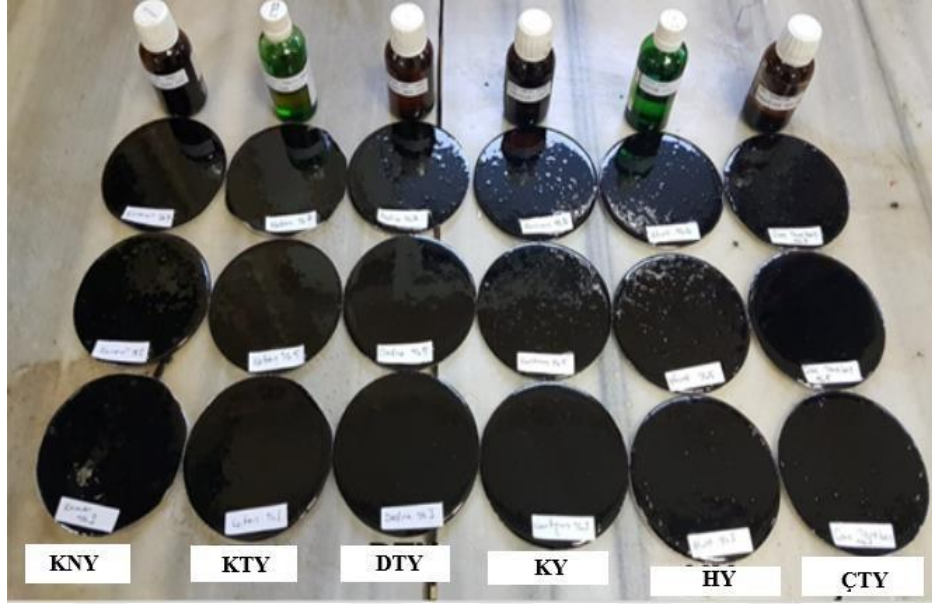
Şekil 2.2. Farklı oranlarda bitkisel yağ ilave edilerek hazırlanan numuneler.
