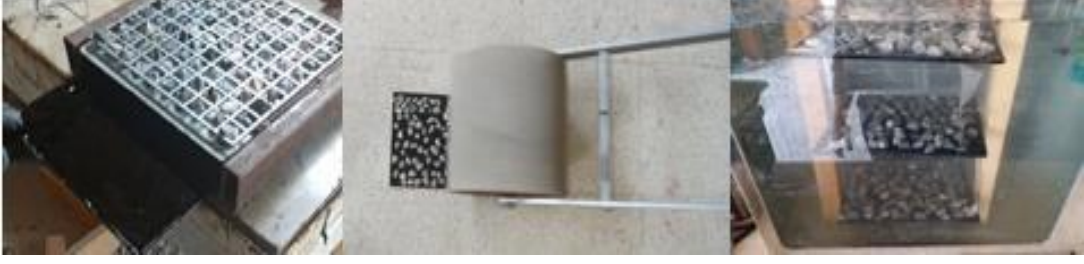
Şekil 3.28. Vialit yapışma deney aşamaları.
