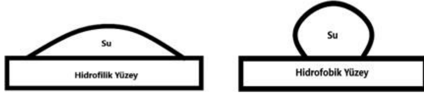
Şekil 1.1. Sırasıyla hidrofilik ve hidrofobik yüzey [7].
