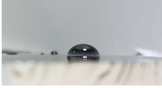
Şekil 3.33. Su damlasının KNY7 numunesi üzerindeki duruşu.
