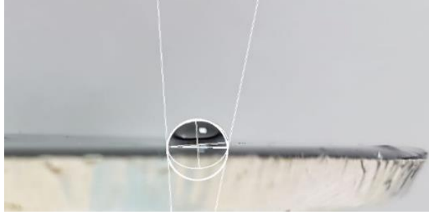
Şekil 3.40. Su damlasının KY7 numunesi üzerindeki duruşunun temas açısı tayini.
