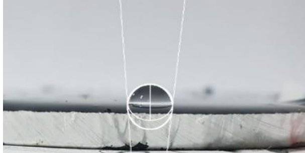
Şekil 3.42. Su damlasının HY5 numunesi üzerindeki duruşunun temas açısı tayini.
