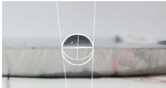
Şekil 3.36. Su damlasının KTY3 numunesi üzerindeki duruşunun temas açısı tayini.
