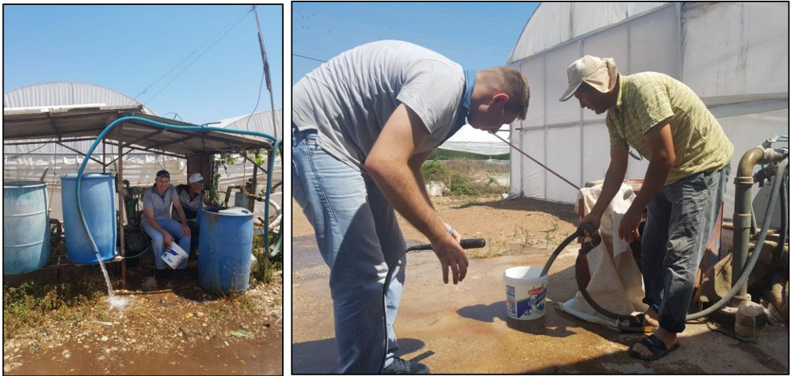
Şekil 3.5. Sondaj borusundaki suyun boşaltımı ve numune alınması
