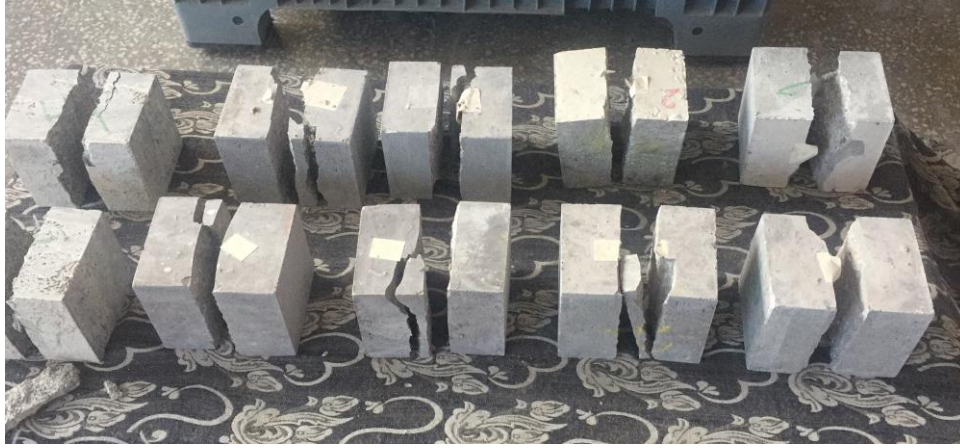
Şekil 3.11. Yarmada çekme dayanımı deney düzeneği
