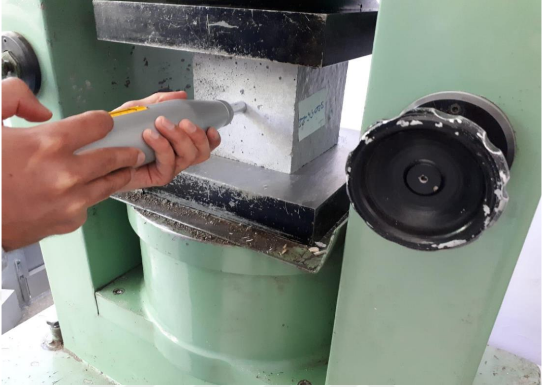
Şekil 3.8. Betonun geri sıçrama değerinin tayini deneyi
