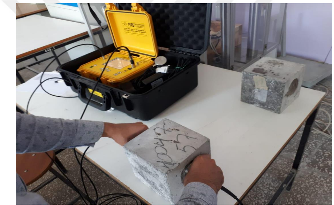
Şekil 3.9. Ultrases geçiş hızı tayini deneyi
