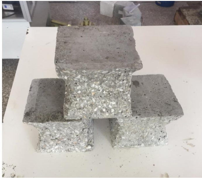
Şekil 3.10. Basınç dayanımı deneyi, numune kırılma şekilleri
