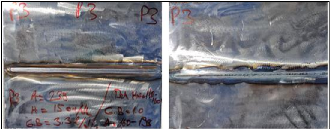
Şekil 3.20. Plazma Ark kaynağı 3. numune ön ve arka yüzü
