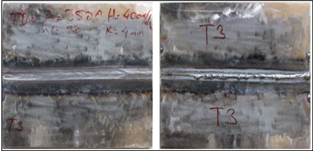
Şekil 3.12. Tozaltı (tek taraf) kayağı 3. Numune ön ve arka yüzü
