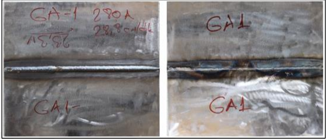
Şekil 3.14. Gazaltı kaynağı 1. Numune ön ve arka yüzü
