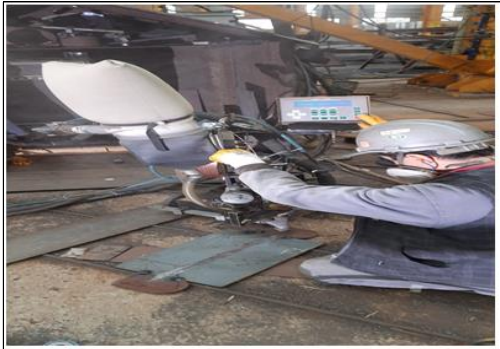
Şekil 3.5. Tozaltı (çift taraf) kaynağı
