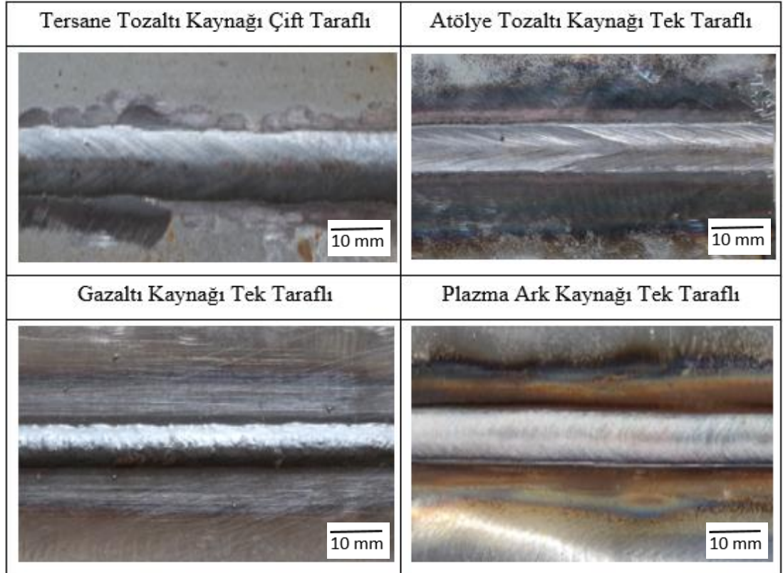
Şekil 4.31. Kaynak dikişi Kep görüntüleri
