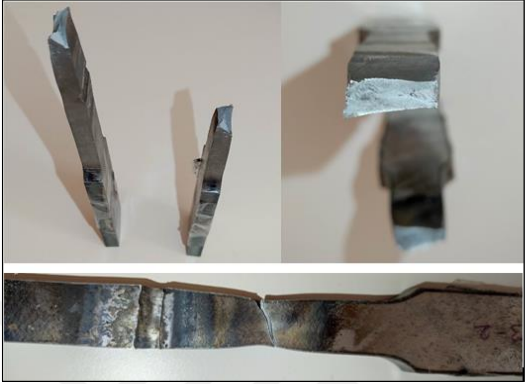
Şekil 4.11. Tozaltı (tek taraf T3) numunesi kırılma görseli
