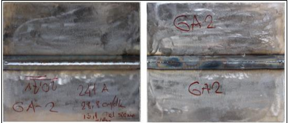
Şekil 3.15. Gazaltı kaynağı 2. Numune ön ve arka yüzü
