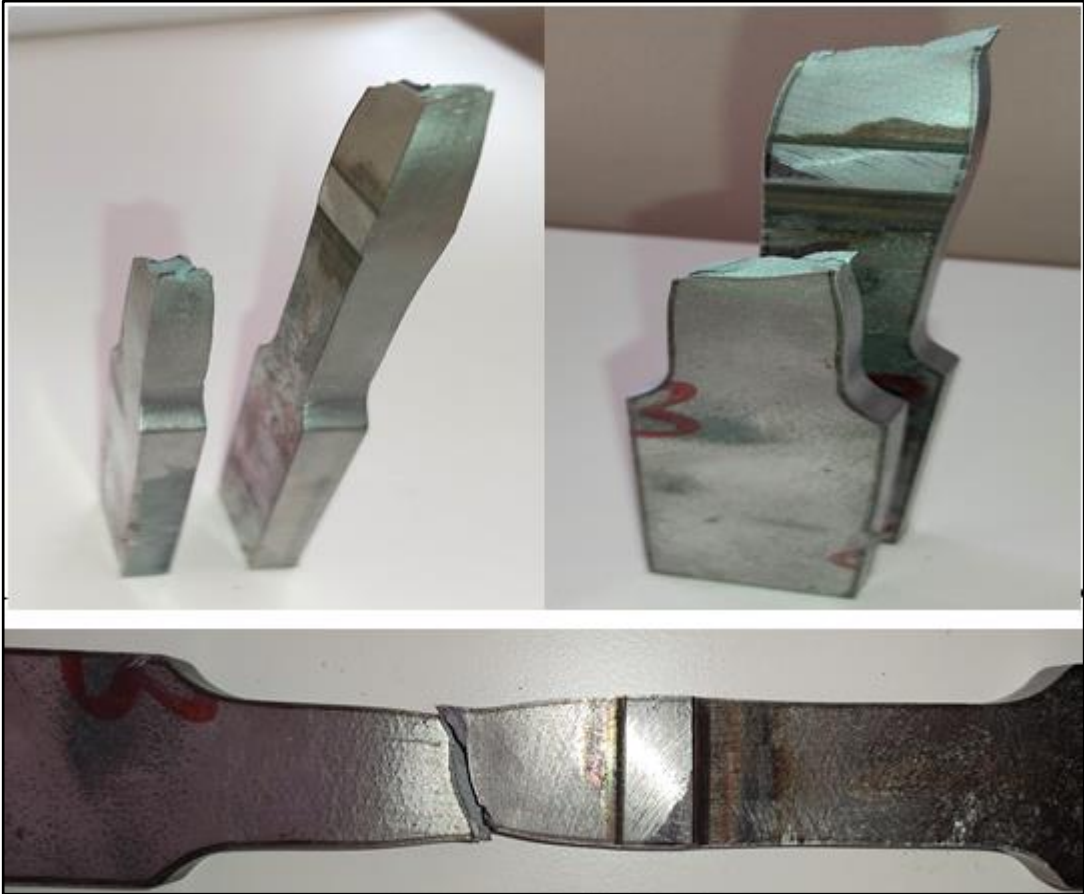
Şekil 4.14. Plazma (P3) çekme numunesi kırılma görseli
