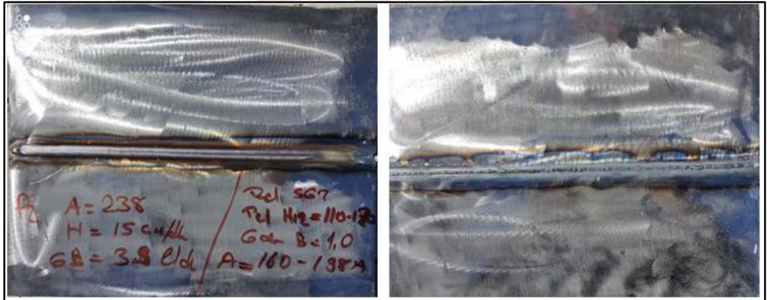
Şekil 3.19. Plazma Ark kaynağı 2. numune ön ve arka yüzü
