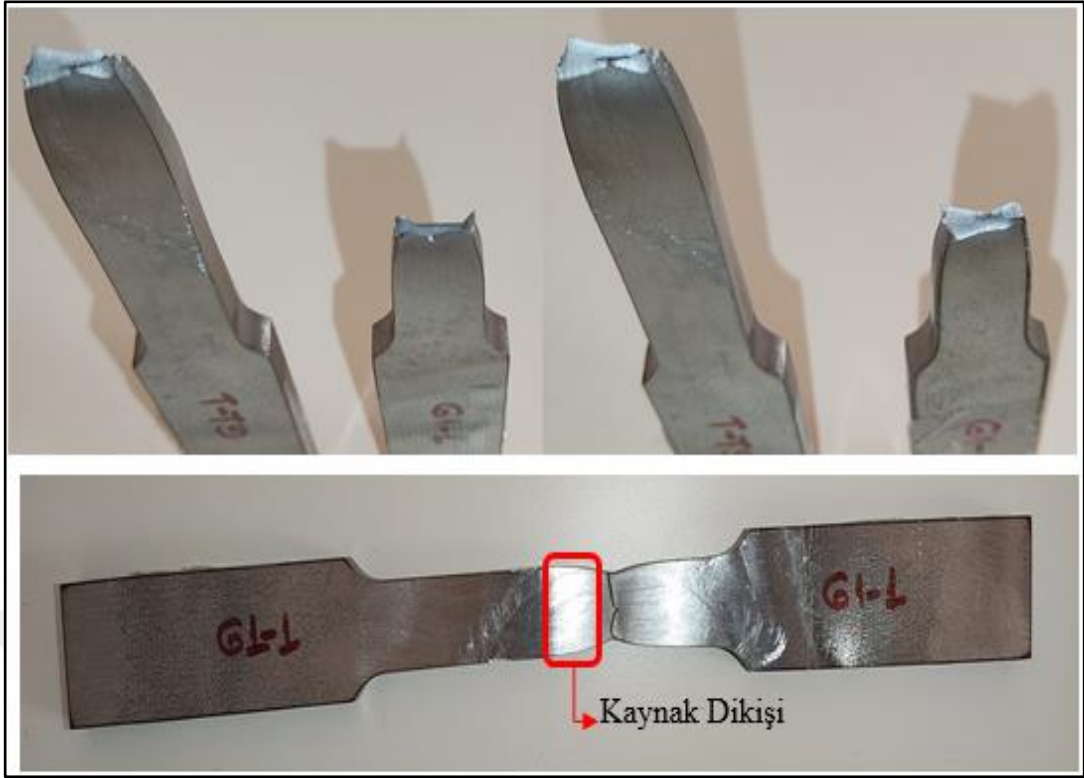
Şekil 4.13. Gazaltı (G1_1) çekme numunesi kırılma görseli
