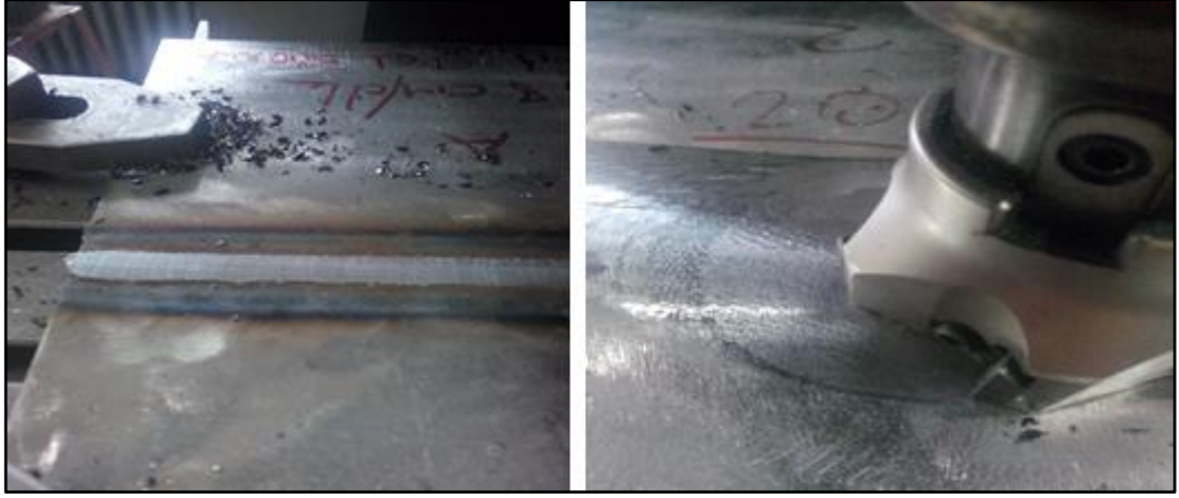
Şekil 3.22. Kaynak dikişlerinin freze tezgahında işlenmesi
