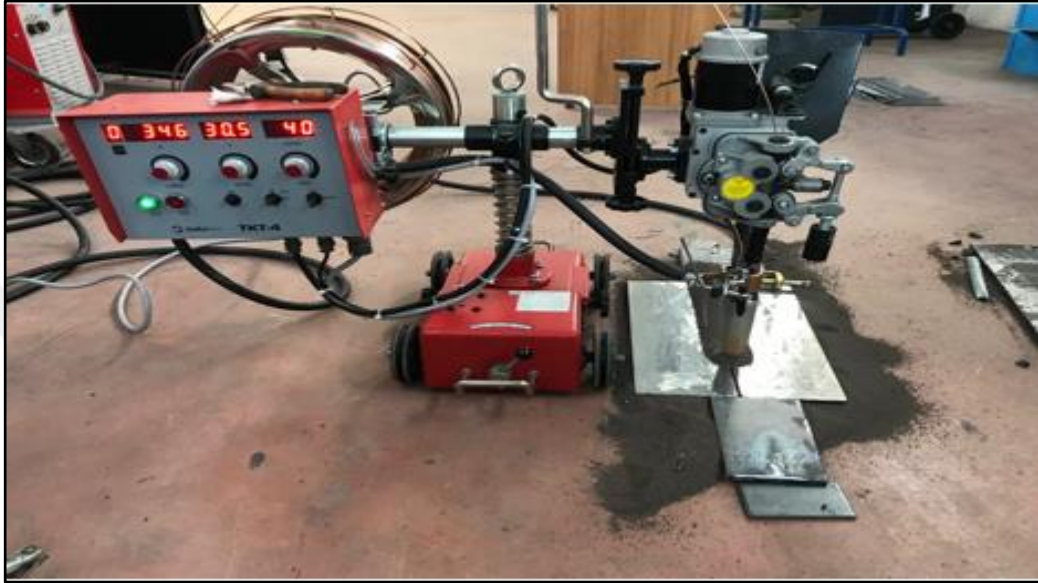
Şekil 3.9. Tozaltı (tek taraf) kaynağı toz altlıklı
