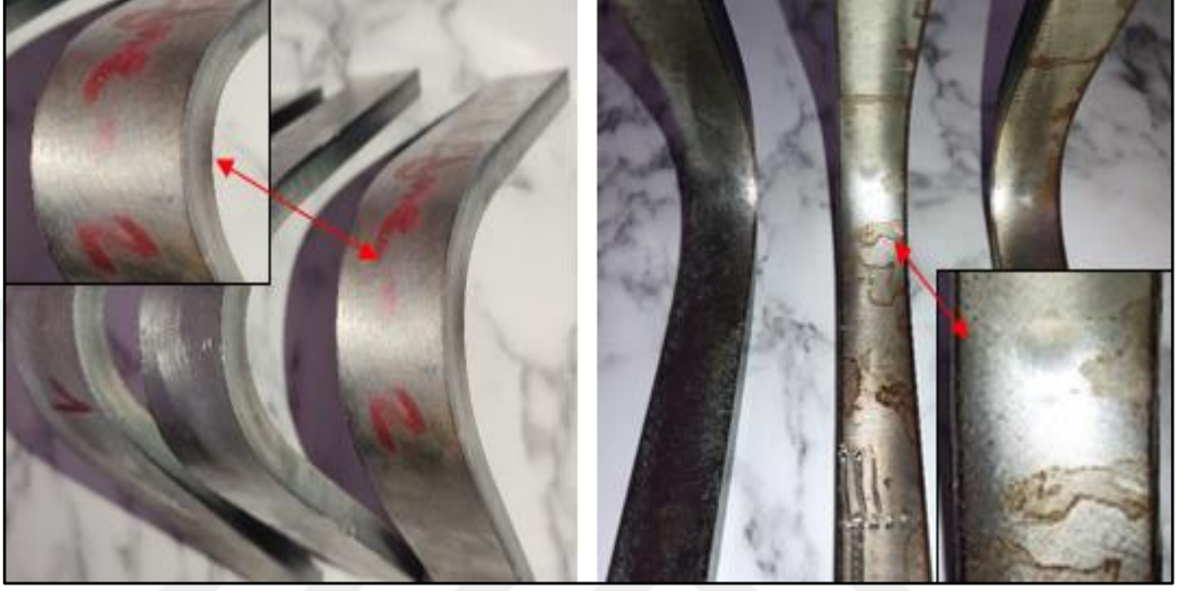
Şekil 4.16. Grade A numunesi eğme sonrası
