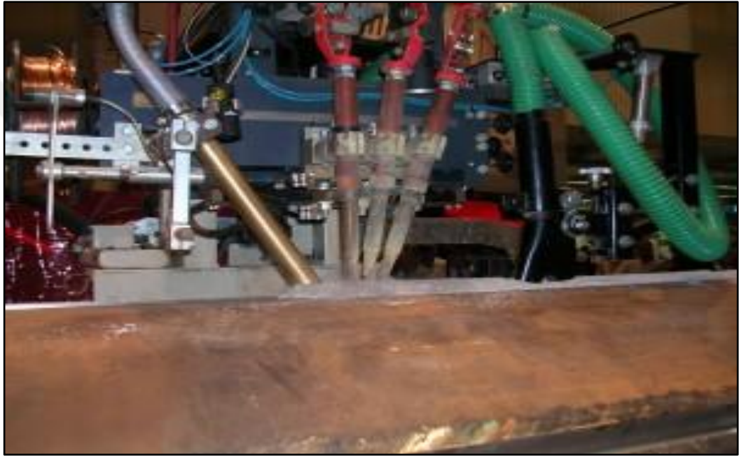
Şekil 2.20. Çoklu tel beslemeli tozaltı kaynak uygulaması (Anonim, 2020)
