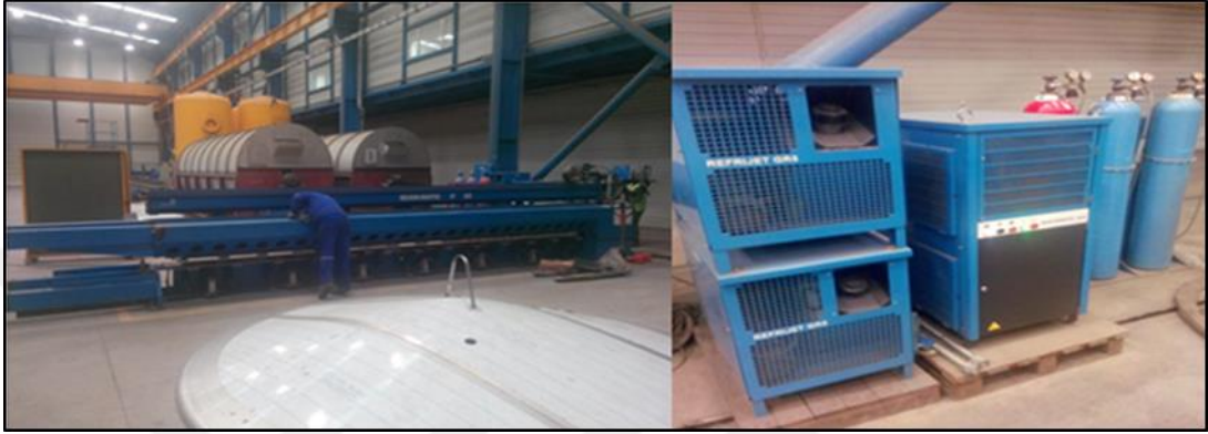
Şekil 3.17. Plazma ark kaynak platformu ve makinesi
