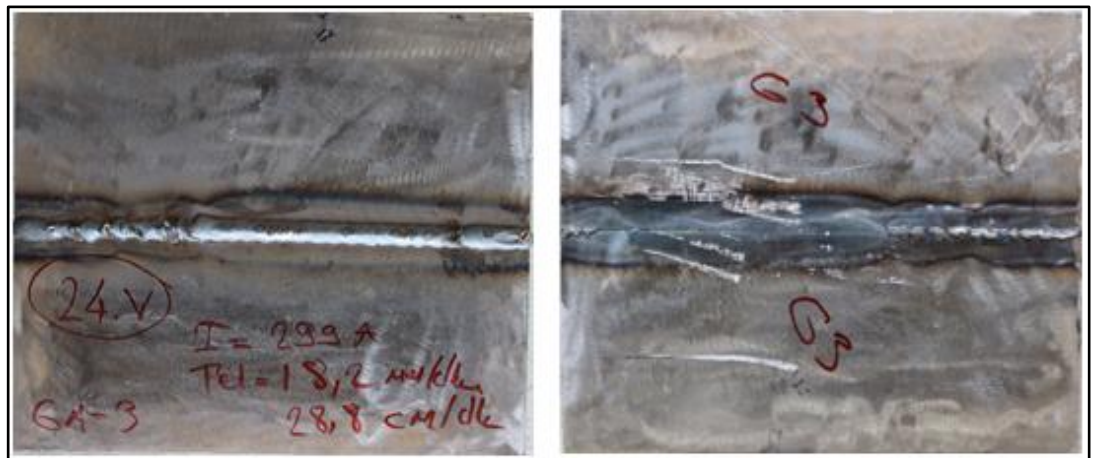
Şekil 3.16. Gazaltı kaynağı 3. Numune ön ve arka yüzü
