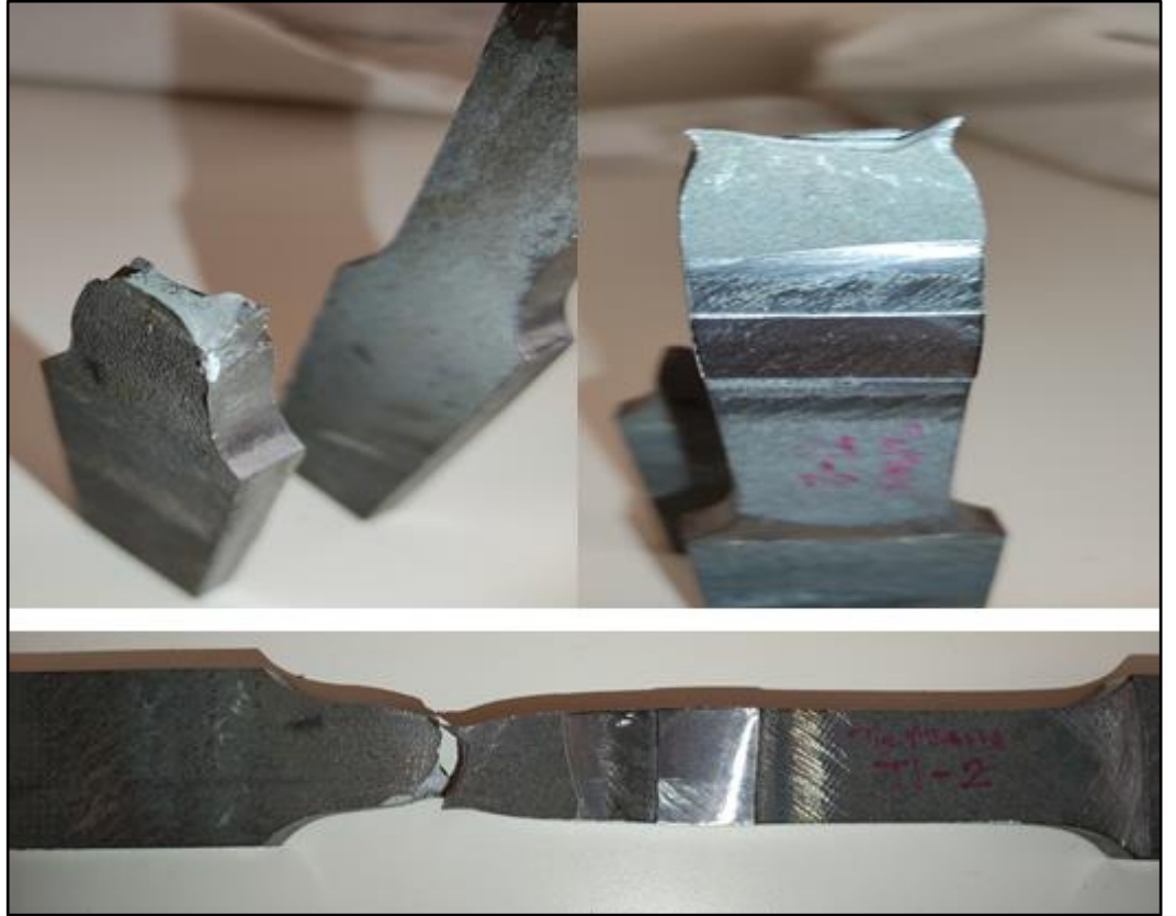
Şekil 4.12. Tozaltı (çift taraf T1) numunesi kırılma görseli
