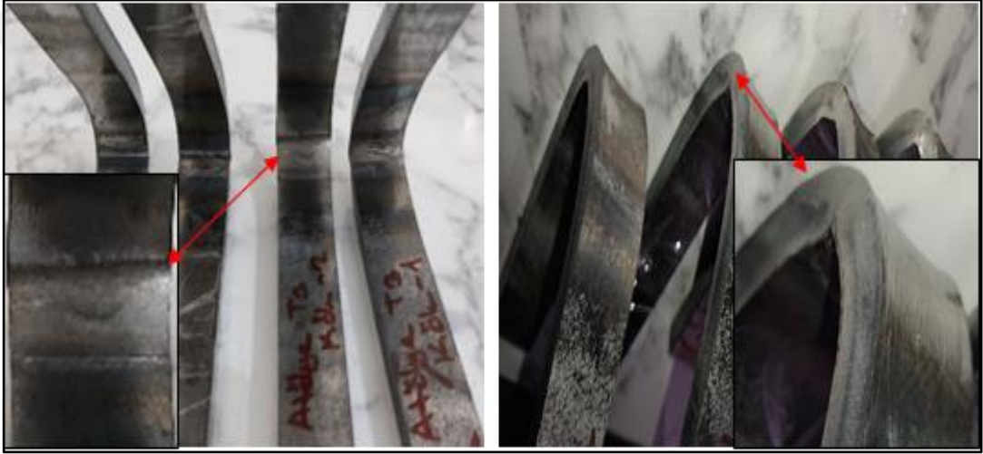
Şekil 4.19. Tozaltı (tek taraf) numunesi eğme sonrası
