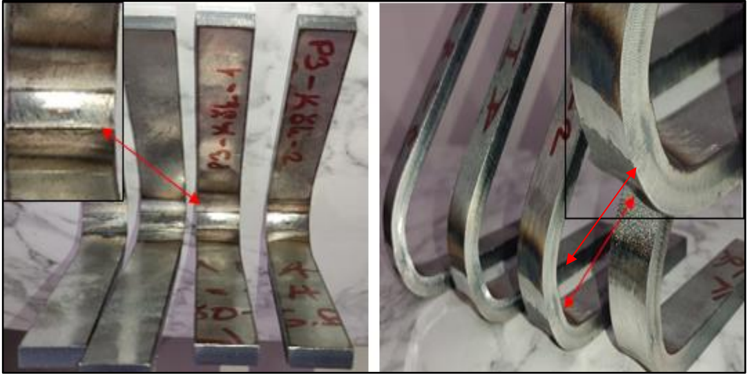
Şekil 4.17. Plazma ark numunesi eğme sonrası
