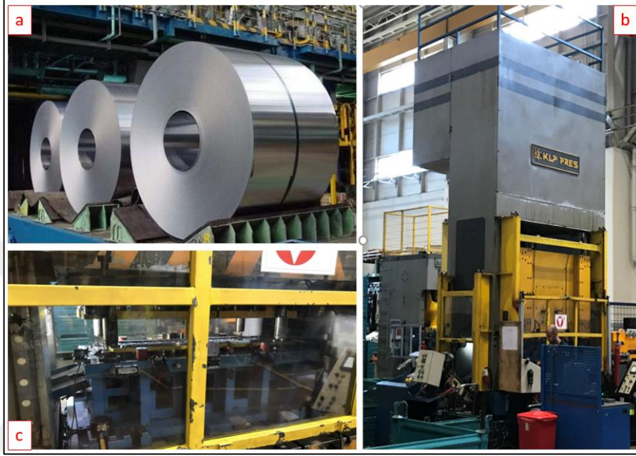
Şekil 2.5: Konektör braket üretimi. a) sac rulo, b) 600 ton pres, c) progresif kalıp.
