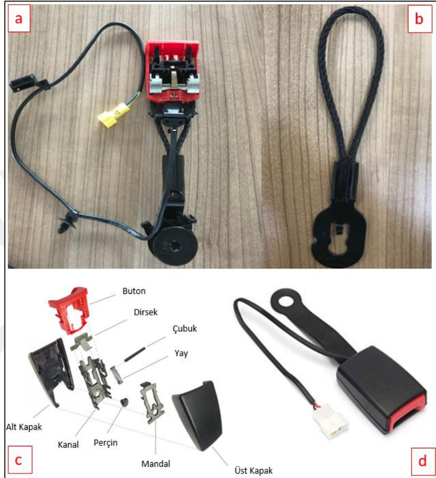
Şekil 1.3: Konektör parçası ve montaj bileşenleri. a) yarı montajlı durumu, b) konektör, c) toka kilidi bileşenleri ve d) montajlı halı.
