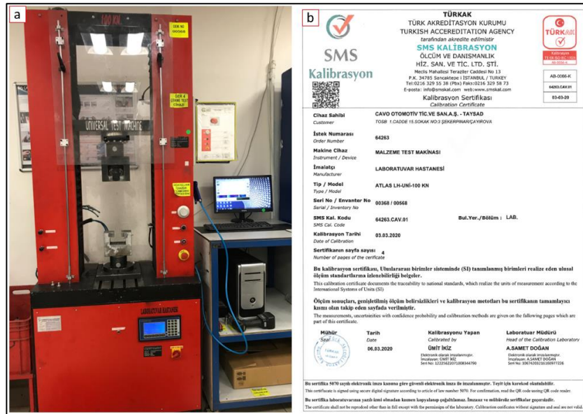
Şekil 4.4: Çekme test cihazı. a) test cihazı görseli, b) kalibrasyon sertifikası.
