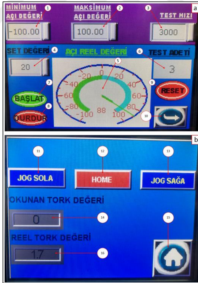
Şekil 3.13: Testi cihazı yazılımının ara yüzü. a) ana sayfa, b) manuel sayfası.
