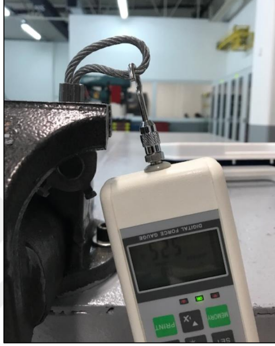
Şekil 3.3: Dinamometre ile halat bükme kuvvet deęeri ölçümü.
