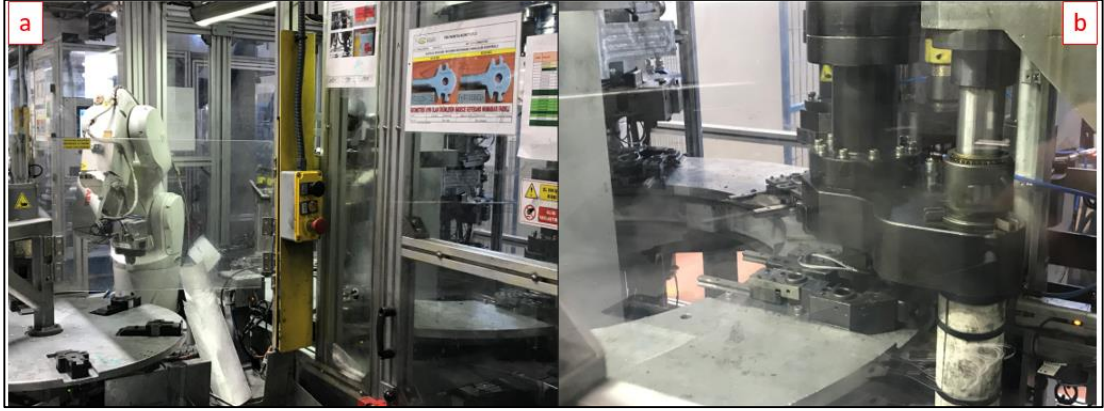
Şekil 2.9: Konektör montaj makinesi. a) makine dış görünüşü b) krimpleme istasyonu.
