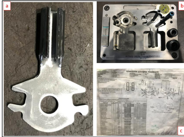
Şekil 2.6: Braket ölçü kontrolü. a) konektör braket, b) master, c) teknik resim.
