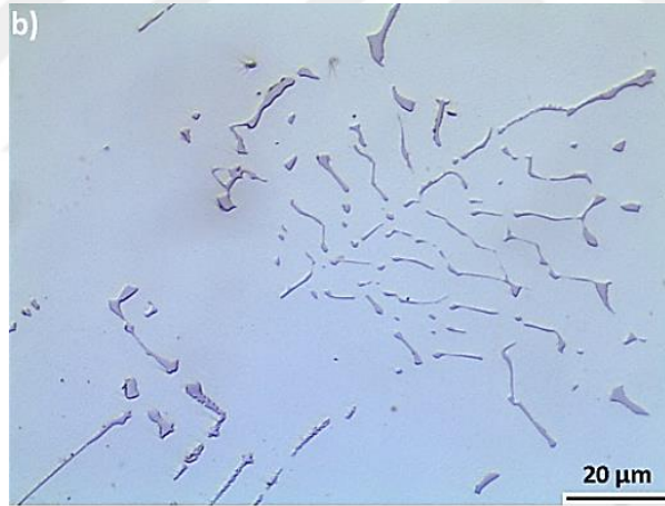
Şekil 4.10 Mar M-247 birincil karbürlerinin morfolojisi – Çin yazısı [49].
