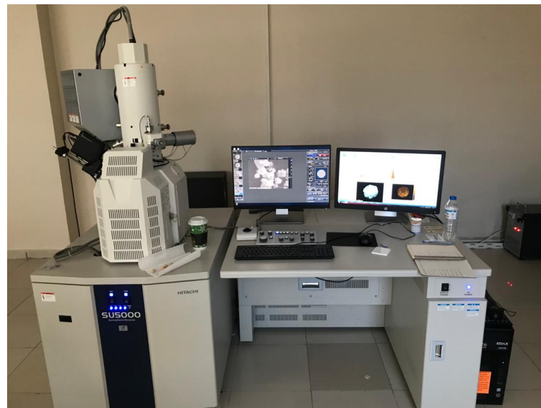
Şekil 6.4. Alan emisyonlu (a) ZEISS, (b) Hitachi marka SEM cihazları
