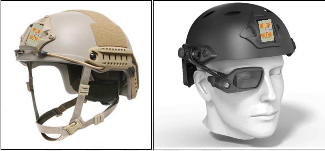
Şekil 6.3: 2x2 Yama Dizi Antenin Kompozit Başlığa Montajı
