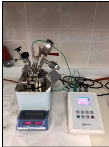
Şekil 2.2: Hidrotermal karbonizasyon yönteminde kullanılan otoklav sistemi.
