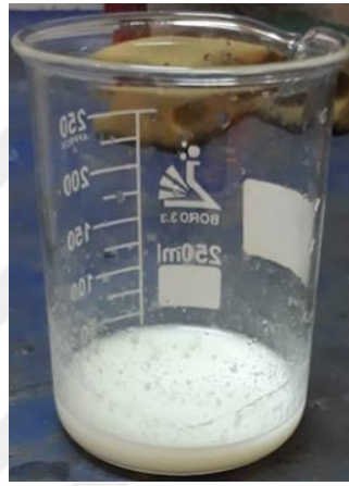
Şekil 4.3. MgO ve Al(OH)_3 başlangıç hammaddeleri kullanılarak elde edilen MgAl_2O_4 trane kompleksi
