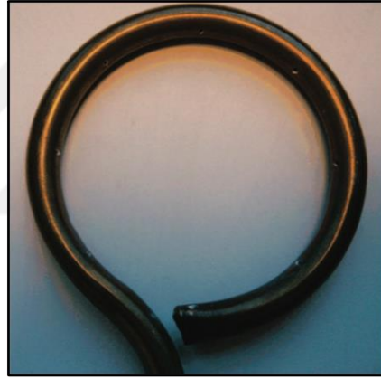
Şekil 2.6. Kaplama kimyasalının buhar formunda reaktöre beslendiği 8 delikli torus halkası [59]
