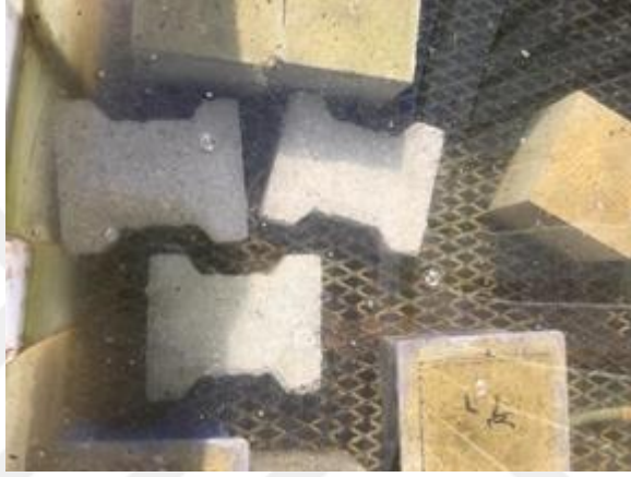
Şekil 2.20. (20 \pm 5)^\circ\text{C} Sıcaklıkta Su Havuzundaki Numuneler
