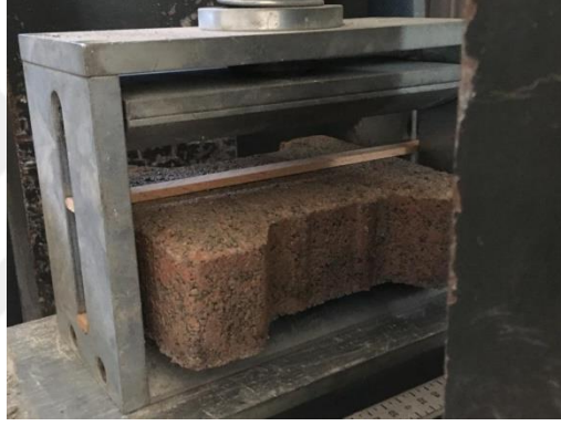
Şekil 2.18. Yarmada Çekme Deney Düzenegi
