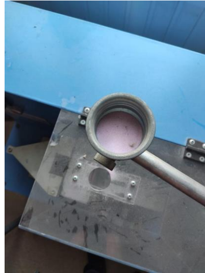
Şekil 2.22. Aşınma Direnç Tayini Cihazı ve Zımpara Tozu
