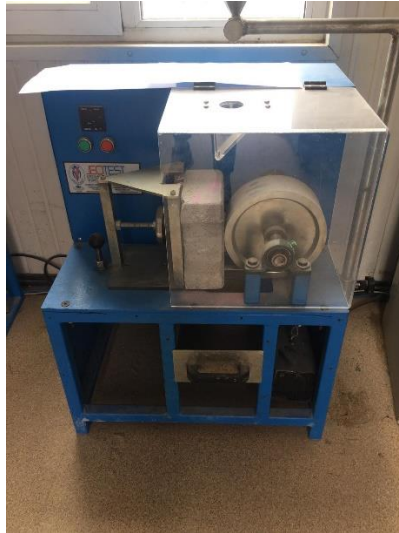
Şekil 2.22. Aşınma Direnç Tayini Cihazı ve Zımpara Tozu
