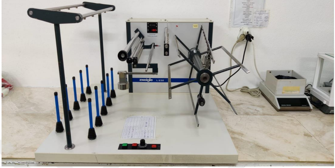
Şekil 3.22. Zweigle L232 iplik sağma çıkırığı ve hassas terazi
