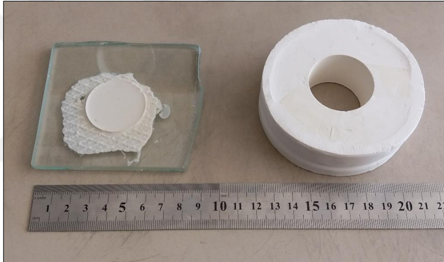
Őekil 3.2: SA kodlu numunelerin retimini iin hazırlanan alı kalıp ve kapak.
