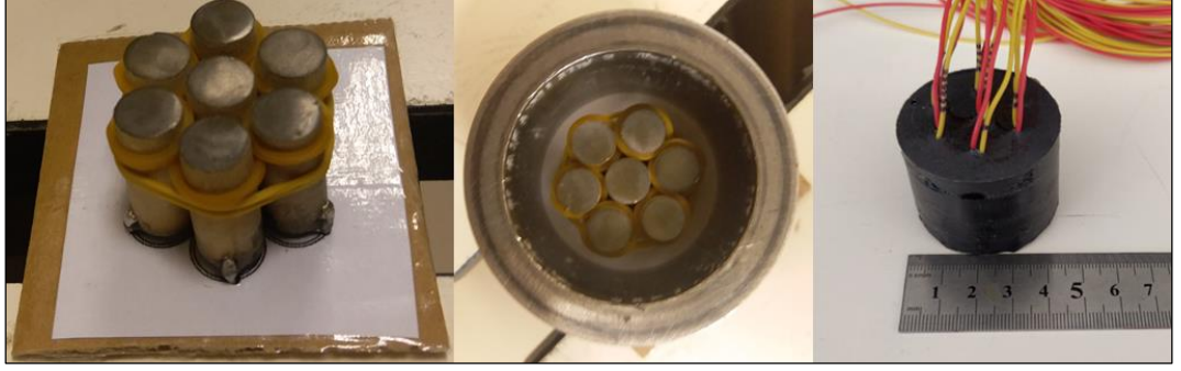
Şekil 3.6: Yedili dizin için poliüretan kaplama aşamaları.
