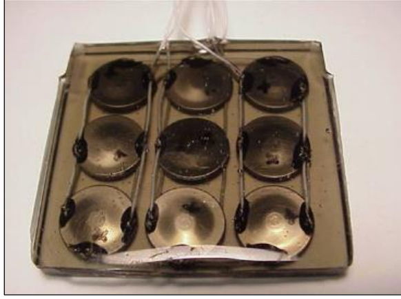
Şekil 2.10: Cymbal dönüştürücülerle hazırlanmış bir dizin.
