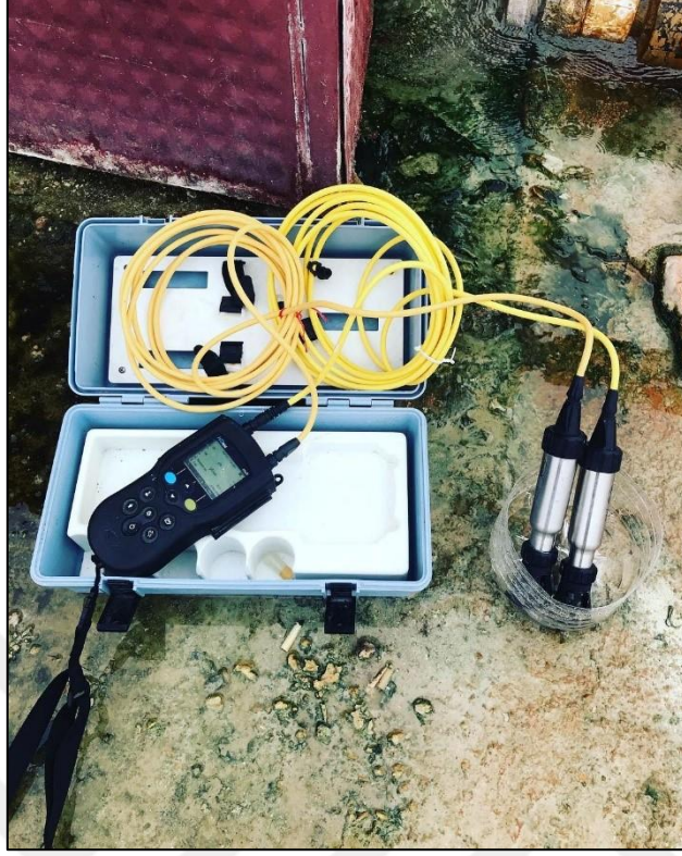
Şekil 3.2 Hach Lange H40QD marka su ölçüm cihazı.
