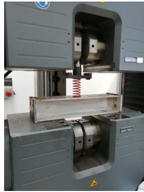
Şekil 2.17. Yaya uygulanan basma testi ve cihazı.
