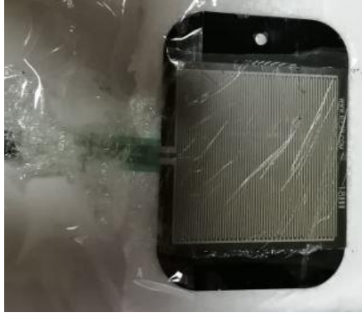
Şekil 2.19. Cihazda kullanılan kuvvet sensörü.
