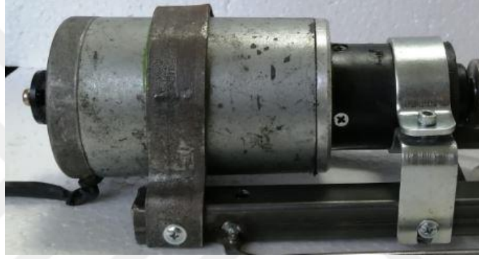
Şekil 2.3. 12V, 140W DC redüktörlü motor.
