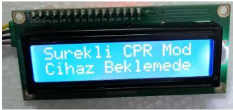
Şekil 2.7. Sürekli CPR modunda LCD ekran görüntüsü.
