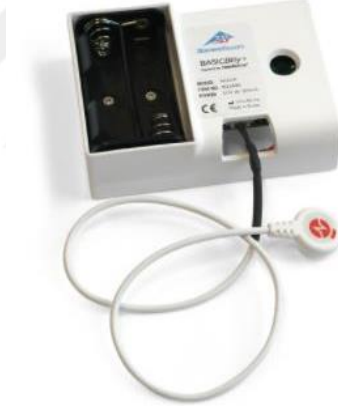
Şekil 2.14. BASICBilly+ model CPR mankeninde kullanılan veri alma modülü.
