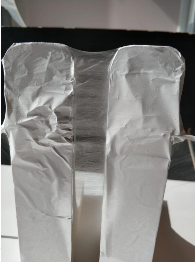
Şekil 26. Birbirinden ayrı iki toplayıcı plaka arasında yönlendirilmiş fiberlerin fotoğrafları
