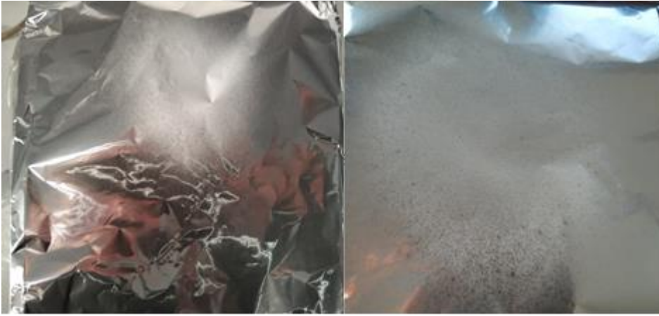
Şekil 24. %15 (w/v) Üçlü çözücü sistemi ile elde edilmiş ipek fibroin solüsyonunun elektroeğirme işlemi sonucu alüminyum folyo üzerindeki oluşmuş damlacık yapıları. Düzgün fiber oluşumu gözlenememiştir.
