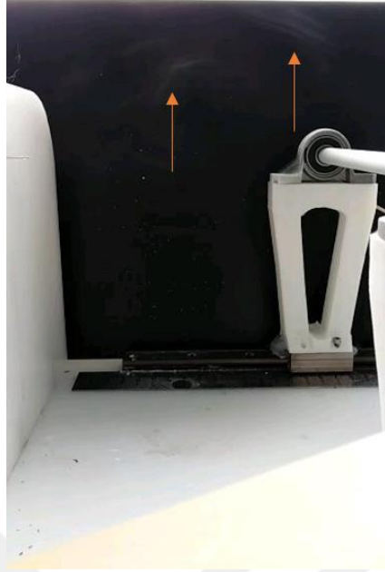
Şekil 4. Dönen toplayıcı düzeneği (Turuncu oklar tambura doğru çekilen fiberleri göstermektedir.)
