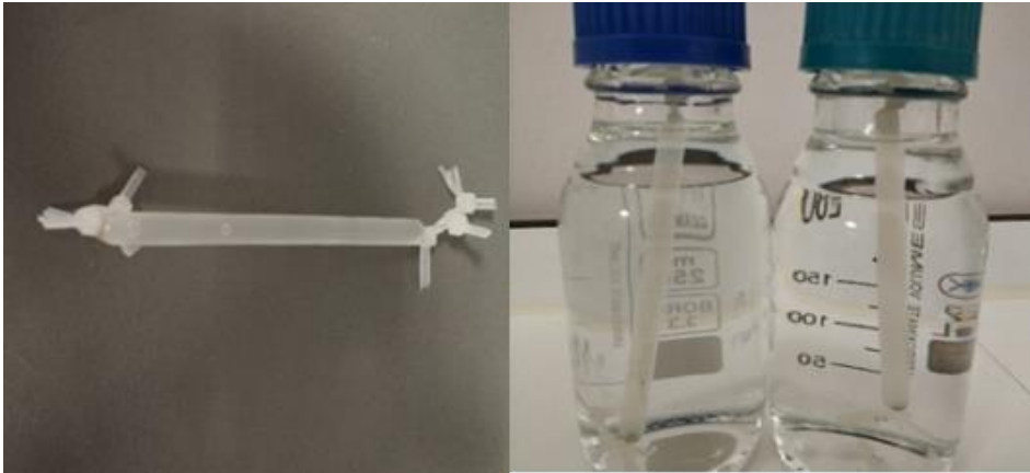
Şekil 12. Yüklenmiş ve diyalize hazır selüloz membranların fotoğrafı
