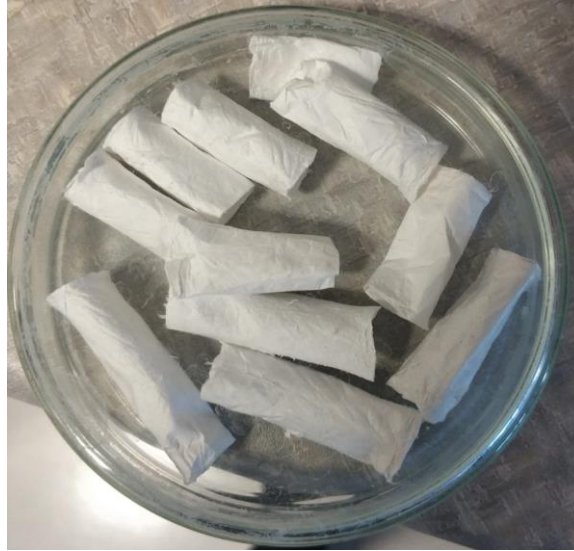
Şekil 28. Dönen tambur sistemi kullanılarak üretilen silindirik iskeleler
