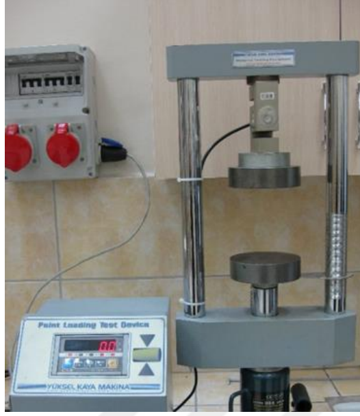
Şekil 5.5. Peletlerin kuru mukavemetlerini ölçmek için kullanılan pelet mukavemeti ölçüm cihazı.
