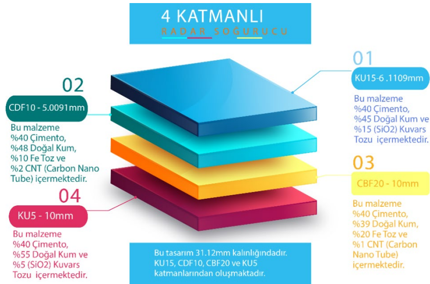
Şekil 5.9 : 4 katmanlı mikrodalga kalkanlayıcı.
