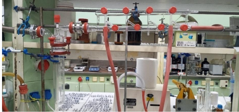
Şekil 2.6. Schlenk hattı (dinamik vakum/gaz düzeneği)
