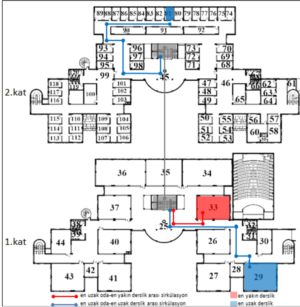
Şekil 4.36. P6 kodlu yapı 1. kat ve 2. kat arası oda-derslik ilişkisi
