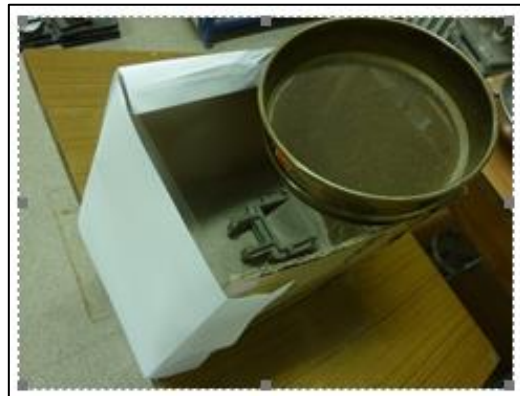
Şekil 69. Kesme kutusu test numunelerinin hazırlandığı yağmurlama düzeneği
