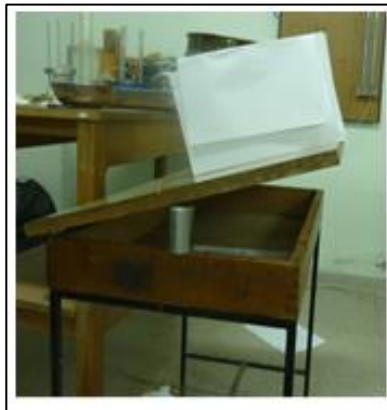
Şekil 69. Kesme kutusu test numunelerinin hazırlandığı yağmurlama düzeneği
