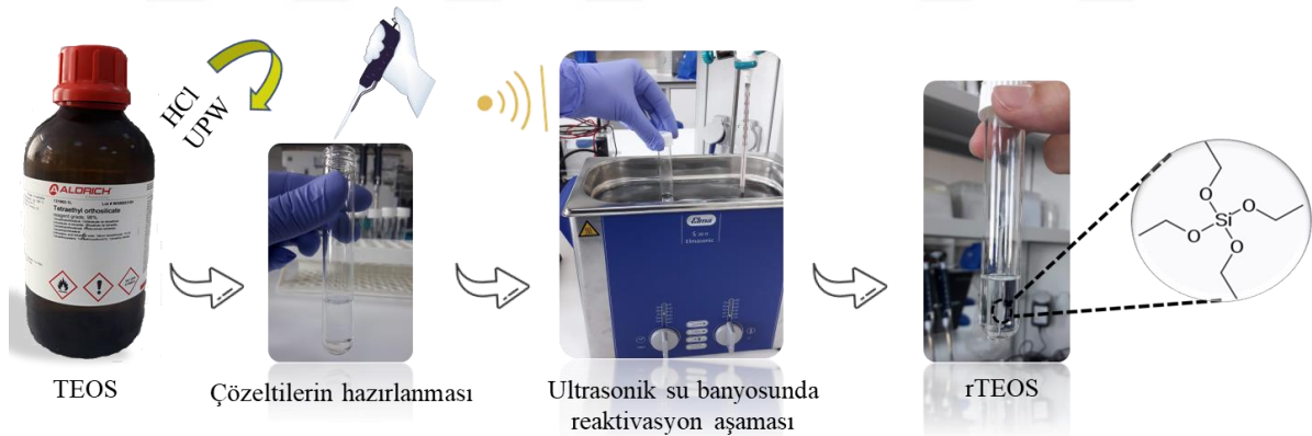
Şekil 23. Asit katalizli ortamda hidroliz ile rTEOS'un eldesi
