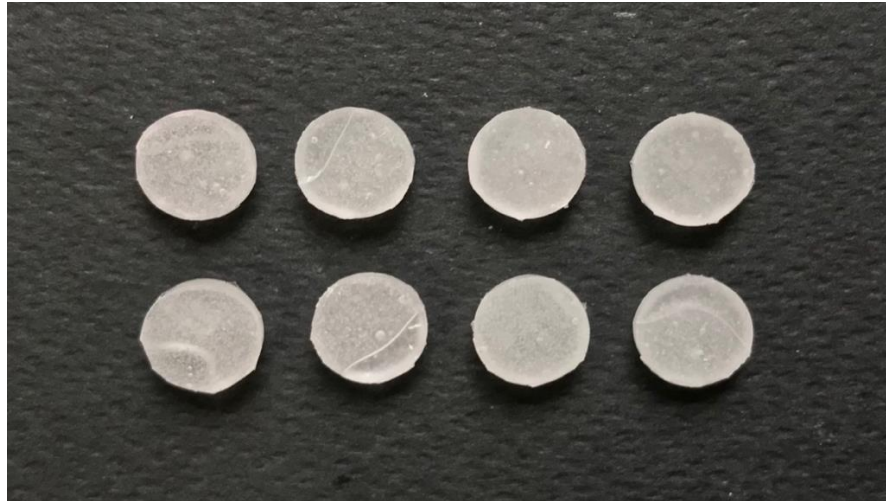
Resim 7. Visco-gel yumuřak astar materyali ile hazırlanan kontrol grubuna ait örnekler
