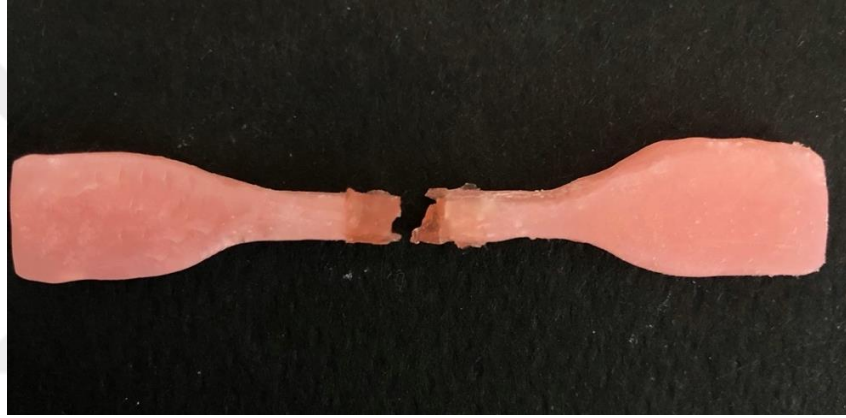
Resim 27. Tokuyama %2 oranında çay ağacı yağı içeren örnekte koheziv kopma tipinde başarısızlık
