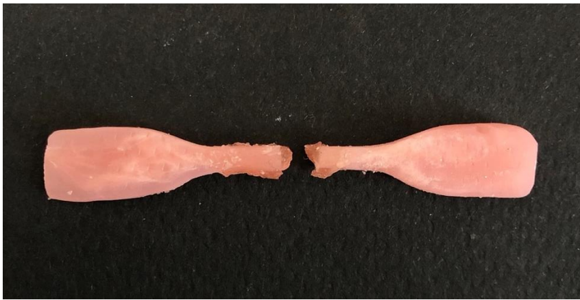
Resim 28. Molloplast B %2 oranında çay ağacı yağı içeren örnekte mixt kopma tipinde başarısızlık
