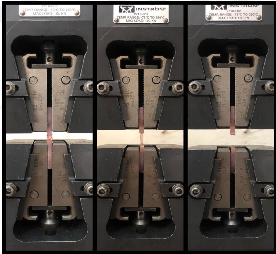
Resim 23. Çekme bağlantı dayanımı testinin uygulanması
