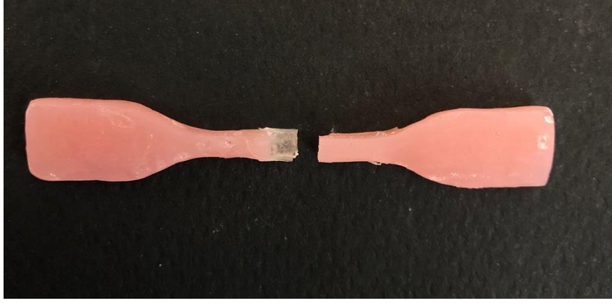
Resim 29. Visco-gel %2 oranında ay aėacı yaėı ieren rnekte adeziv kopma tipinde bařarıszlık
