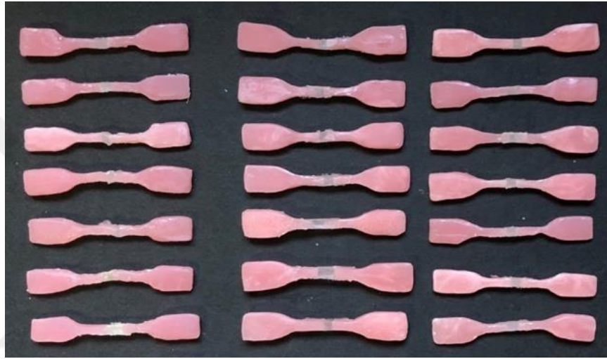
Resim 19. ASTM D 638- 14 standartlarına uygun olarak hazırlanan Visco-gel yumuşak astar materyaline ait örnekler
