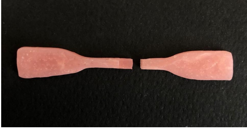
Resim 26. Gc kontrol grubuna ait örnekte adeziv kopma tipinde başarısızlık
