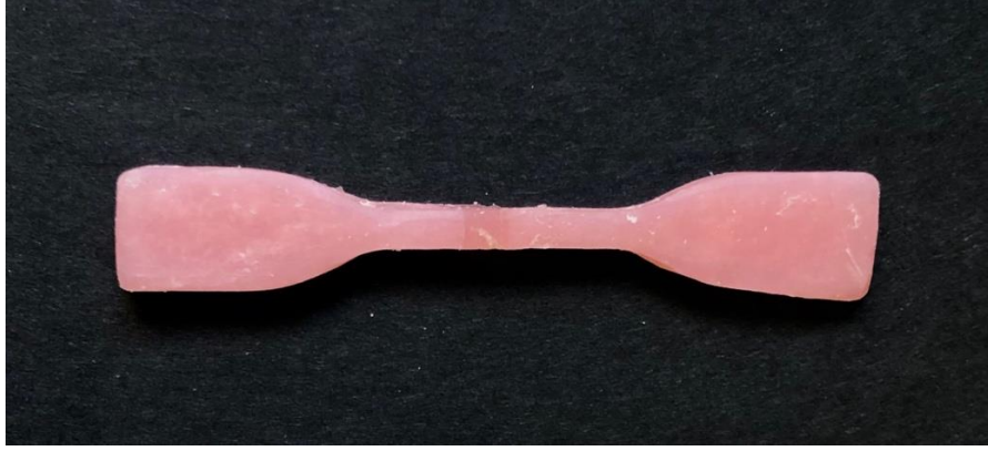
Resim 21. ASTM D 638-14 standartlarına uygun boyutlarda hazırlanan Molloplast B yumuşak astar materyaline ait kontrol grubu örneği
