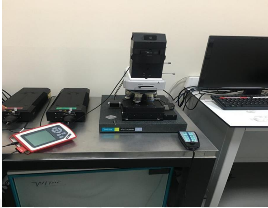
Şekil 21. Raman Spektroskopisi (WITec alpha300 R)
