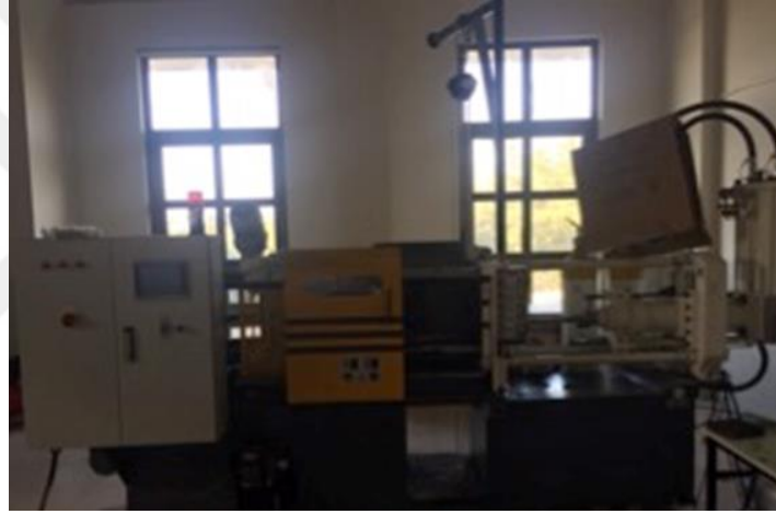
Şekil 0.2. Soğuk hazneli yüksek basınçlı döküm cihazı (HPDC)
