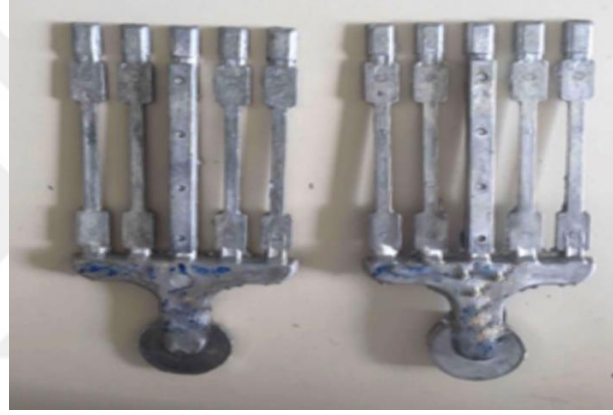
Şekil 0.1. Ce ilavesi ile elde edilen Mg-5Sn-2Al-1Ce ve Mg-5Sn-2Al-2Ce alaşım numuneleri
