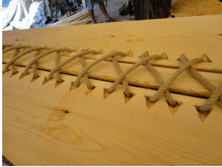
Figür 107: Teknenin dikişlerinden detay (360 Derece Tarih Araştırmaları Derneği arşivi)
